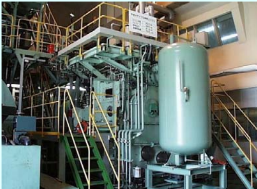
新しい効率向上策～最新の燃焼最適化技術 ＜単気筒性能試験による実証＞
