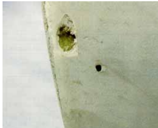
図D.4 落雷でレセプタが脱落した事例
