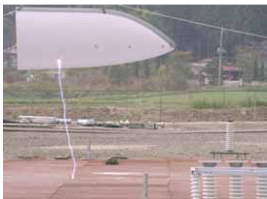
図C1.10 ブレード水平配置の貫通放電例（負極性、汚損無し）
