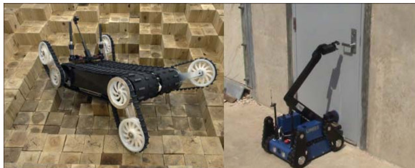
図6 被災建造物内移動RTシステム
