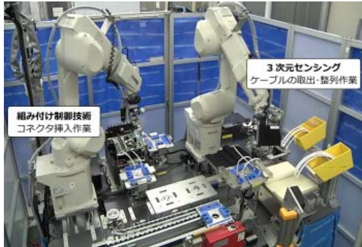
図1 柔軟物も取り扱える生産用ロボットシステム
