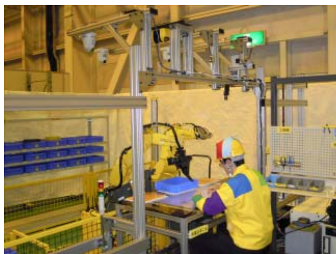
図2 人間・ロボット協調型セル生産組立システム
