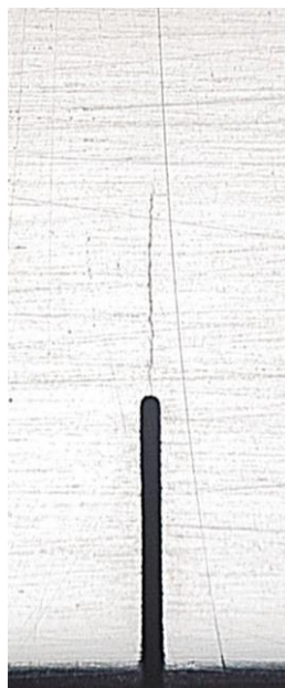
図②-3)-38 N=1.00 \times 10^5 におけるき裂(SUJ2, a=4.98\text{mm} , \Delta K_{N=0}=17.9 \text{ MPam}^{1/2} )
