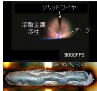
図①-1)-1 従来の純アルゴンMIGの不安定溶接例。溶接欠陥：蛇行ビード、アンダーカットが見られる。
