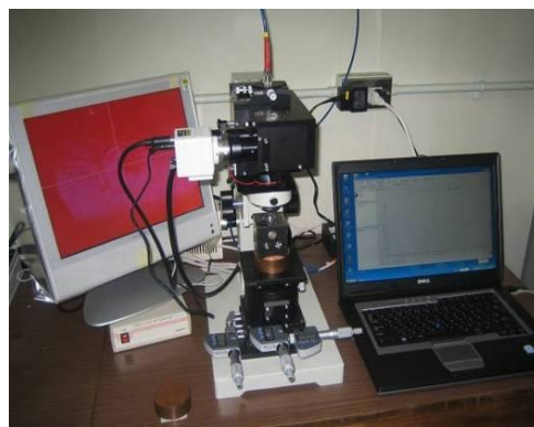
図 III.2.3-(103) 顕微圧力測定装置。高圧水素封入された La 水素化物の圧力を測定している様子を示す。
