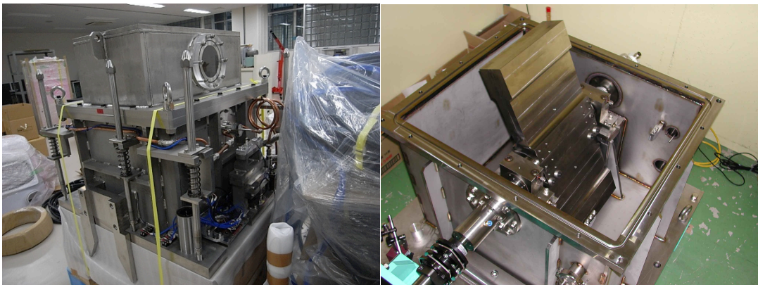
図Ⅲ.2.5.-(10) T0 チョッパーの内部。インコネル製のローターは真空中で回転する。
