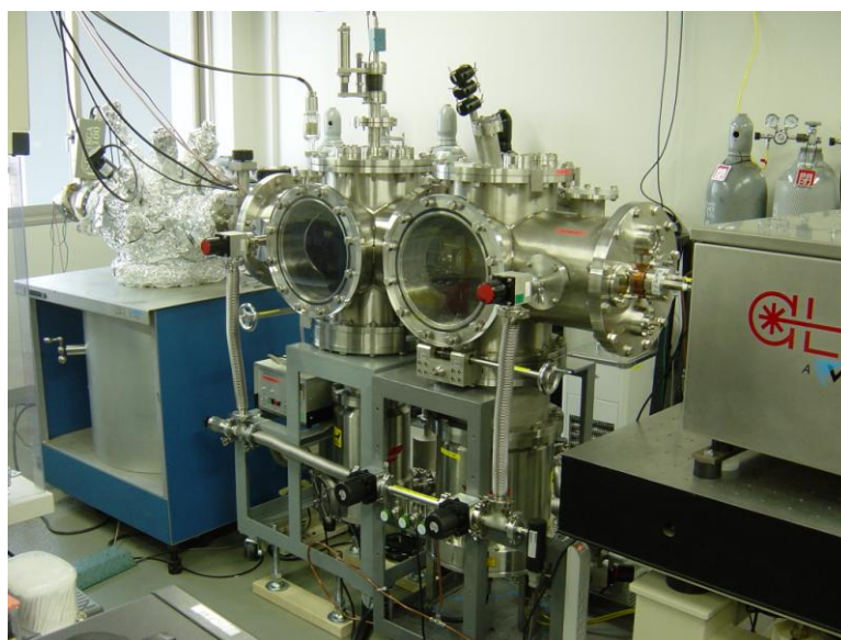
図Ⅲ2.3.-(54) 本研究で用いたレーザーデトネーション原子ビーム発生装置。
