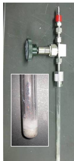
図Ⅲ.2.3.-(97) \text{LaH}_x 試料の作製に用いた石英製の反応容器。挿入図は作製された赤褐色の \text{LaH}_x 絶縁体試料を示す。
