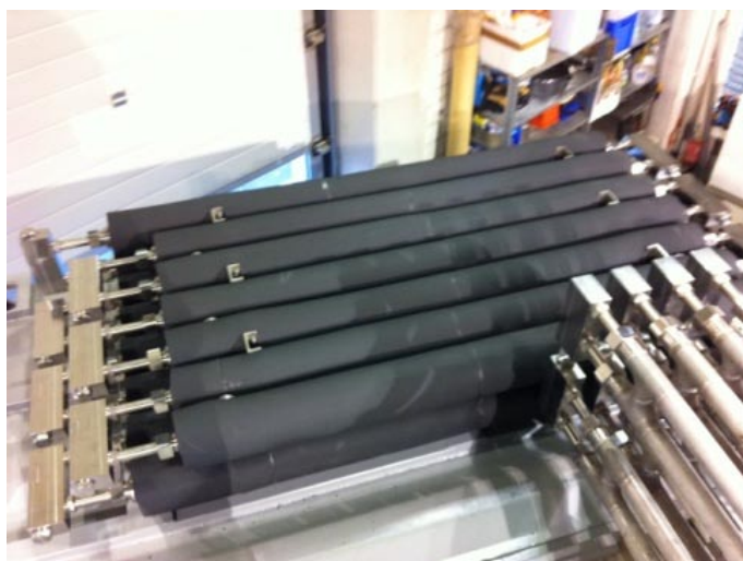
図 2.2.2-14 実用化された高圧水素プレクーラー (HP160)
