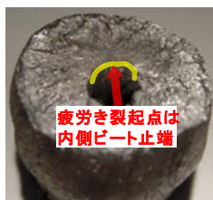
図 2.2.(4).11 欠陥のない溶接試験片の疲労き裂起点
