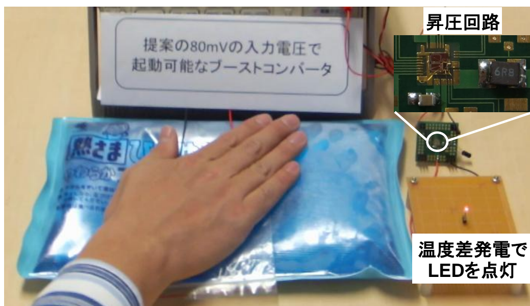
図Ⅲ. 2. 4-23 80mV 入力昇圧回路を用いた温度差発電のデモ
