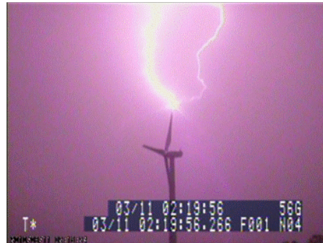
ブレード先端部への着雷観測例 (2011/3/11)
