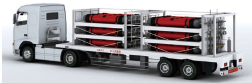
図 6-22 NEDO プロジェクトで実証された 45 MPa トレーラー
