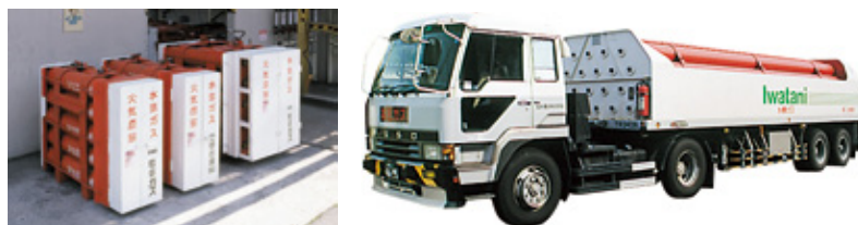
図 6-21 水素カードルと水素トレーラー
