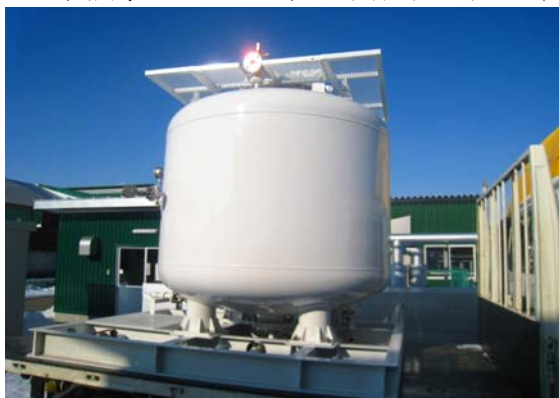
写真：メタン吸蔵容器 (容器容量:4m 3 、メタン吸蔵量:200m 3 N)
