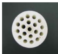
ノリタケ殿提供 マルチチャンネル 基材 (外径30mmφ、19 穴)
