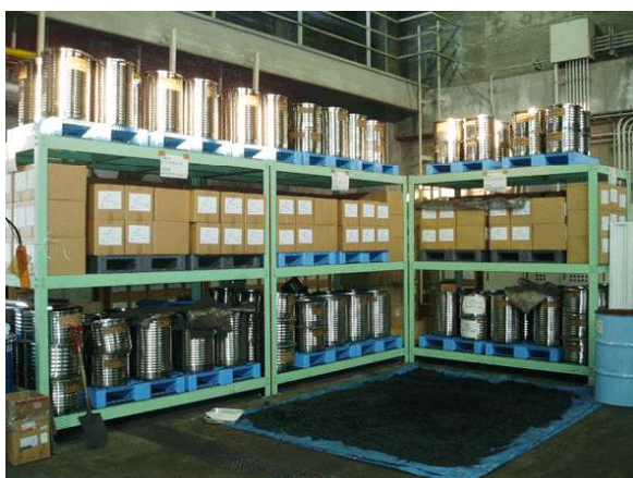
図 III-2.1-2 標準試料の保管形態（左：気密容器、右：ラミネート包装）
