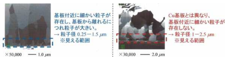
図 III-2.2.2-5 粒成長に及ぼす基板素材の影響 (SIM 像)
