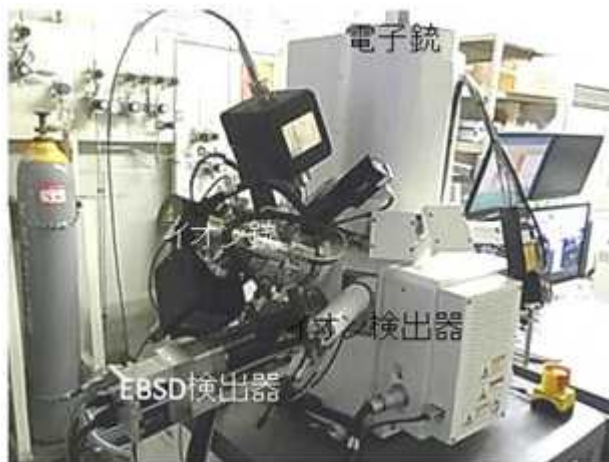
図Ⅲ-2.1.2-8 電子銃,イオン銃,各検出器の配置
