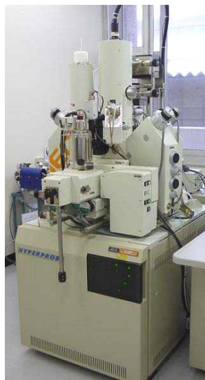
図Ⅲ-2.1.3-3 炭素分配分析用 FE-EPMA の概観
