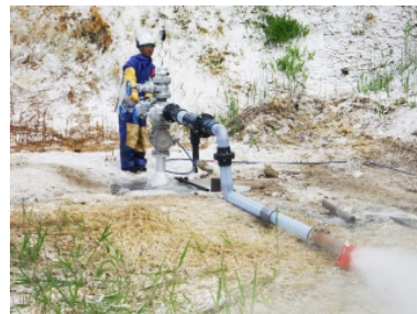
図IV(4.6)-2 二相流仮設配管噴気状況でのジェット洗浄実証実験状況
