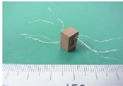
図 I .2.5.4.3-20 ブロック形状に焼結したペーストのヤング率測定
