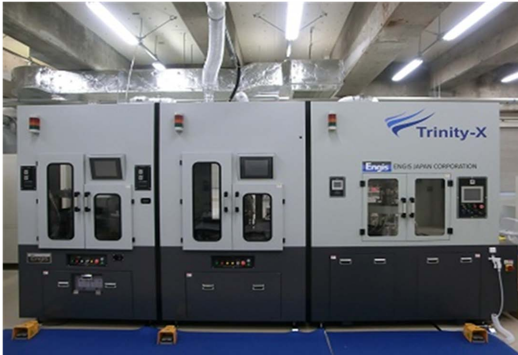
図Ⅲ. 2. 2-26 導入した大口径対応研磨盤 TRINITY-X（日本エンギス株式会社製）
