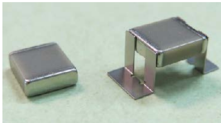
図Ⅲ. 2. 5. 1-38 複合ペロブスカイト材料を用いた最終レベル部品外観
