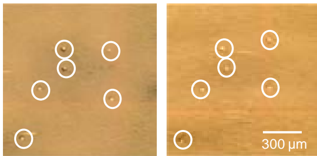
図Ⅲ.2.1.2.1-41 (a) 成長前の種結晶、(b) 成長後の成長層 (成長速度 2.1\text{ mm/h} )の放射光X線トポグラフィ像 ( g=11\bar{2}8 )。
