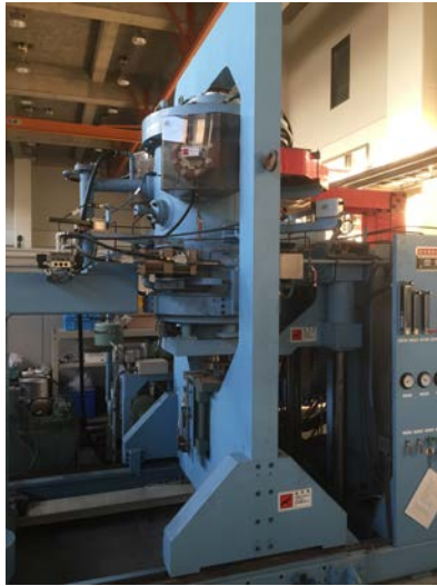
図Ⅲ.2.5.3-23 雰囲気制御加圧焼成炉の写真
