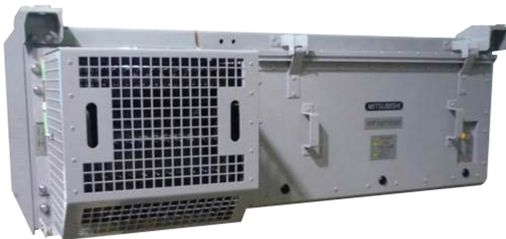
図Ⅲ. 2. 4. 2-38. フル SiC 適用インバーター装置
