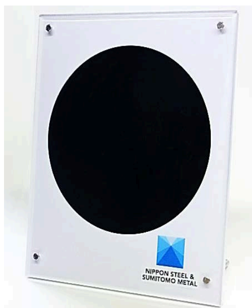
図 III.2.1.1.2-3 開発した 6 インチ単結晶ウエハ
