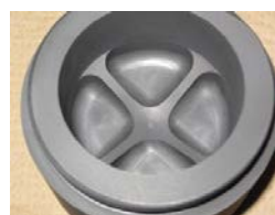
図Ⅲ.2.1.2.2-16 羽根構造による溶液対流制御
