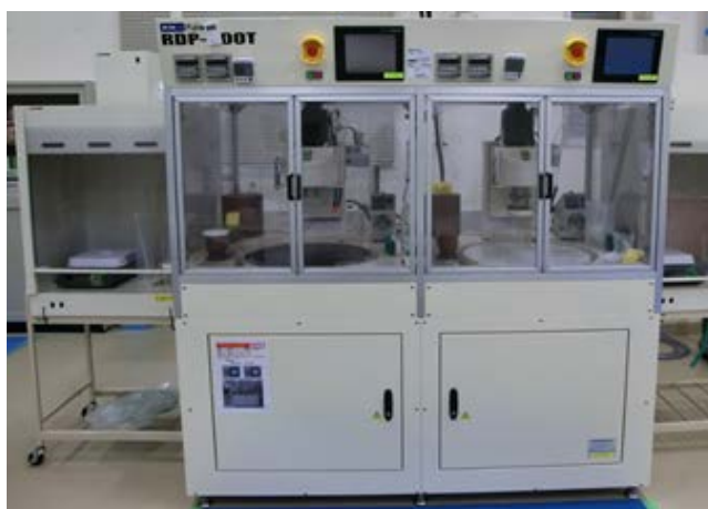
図 III. 2. 2-43 CMP 装置 RDP-500T (不二越機械工業(株)製)
