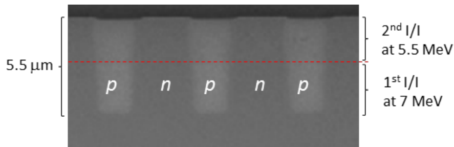
図Ⅲ. 2. 4. 1-77 2 段の MeV 注入により形成した SJ 構造の断面 SEM 像
