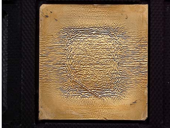
図Ⅲ. 2.5.6-157 2000 サイクル後の Al ベースプレートサンプルの裏面
