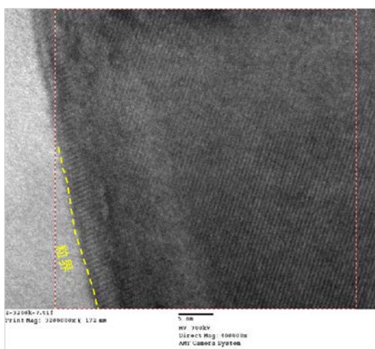
図Ⅲ.2.5.1-8 図Ⅲ.2.5.1-7○部分の拡大画像（格子像）（111 入射）
