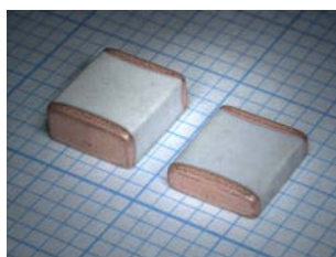
図Ⅲ.2.5.1-9 試作した最終レベル部品 ※青線のマス目は 1mm
