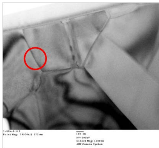
図Ⅲ.2.5.1-7 試作した積層コンデンサの誘電体層断面 TEM 像 (-111 入射)
