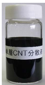
図 2.5.3-3 作製したe-DIPS法単層CNT分散液
