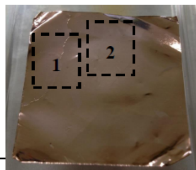
図2.4.4-39 Cu箔上に成膜したグラフェンとそのラマン分光(a)およびスムーズ処理したラマンスペクトル(b)
