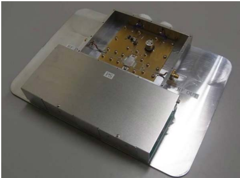
図2.3.2.1-26 サンプル提供例（衛星通信用増幅回路の放熱板）
