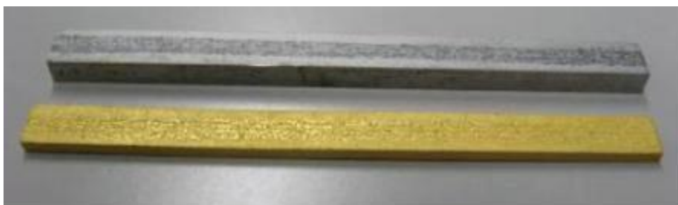
図 2.3.2.1-29 高熱伝導性材料に金メッキを適用
