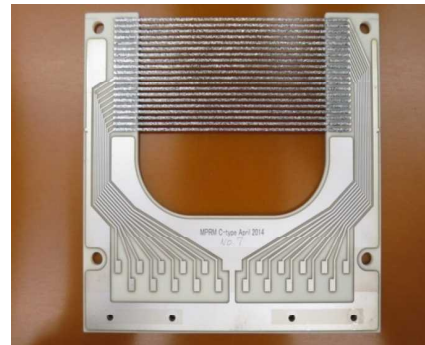
試作したビームセンサー(直角リボンターゲット、写真提供KEK)
