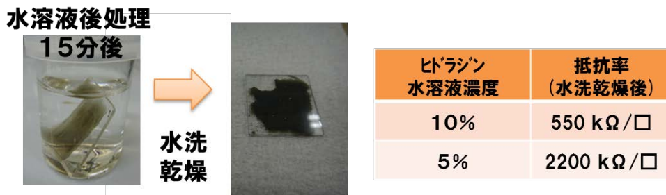
図 2.4.1-2-4-17 ディップ塗布 G r F の液中後処理 (塗膜 0.5%品)
