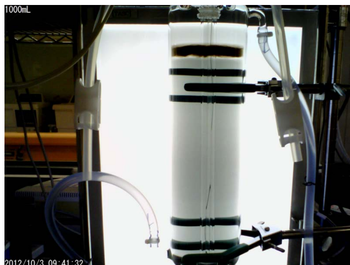
図 2.2.2-29 容量 1000mL の電気泳動槽を用いた eDIPS 合成CNT に対する半金分離処理の画像。
