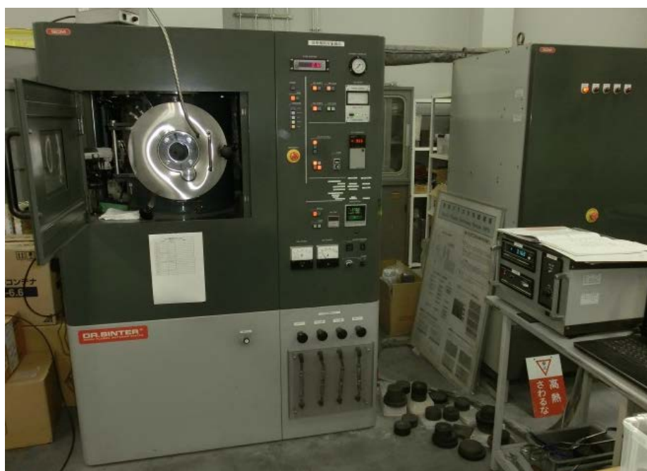
図2.3.2.1-13(a) 小型SPS装置外観 (大阪府立産業技術総合研究所保有装置)
