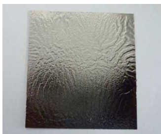
多層グラフェンフィルム (厚さ: 1\mu\text{m} )
