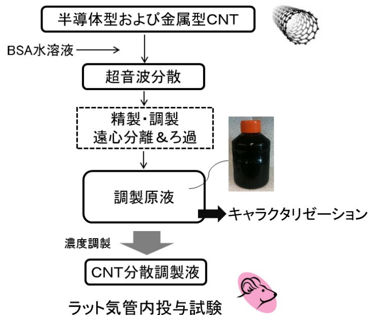
図 2.1.1-2 ラット気管内投与試験のためのCNTの調製とキャラクターゼーション
