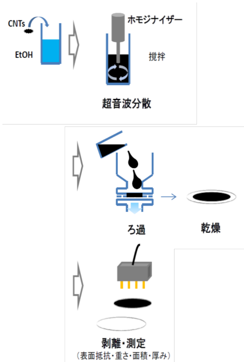
図 2.2.1.1-6 体積抵抗率評価の手順
