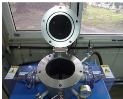
通電加熱炉 外観
