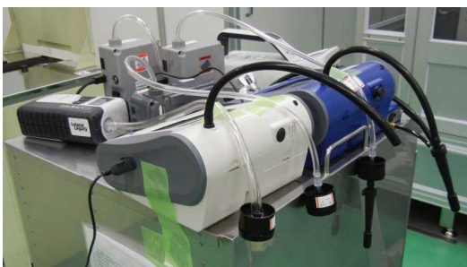
計測器によるモニタリング及びフィルターへの粒子捕集の様子
