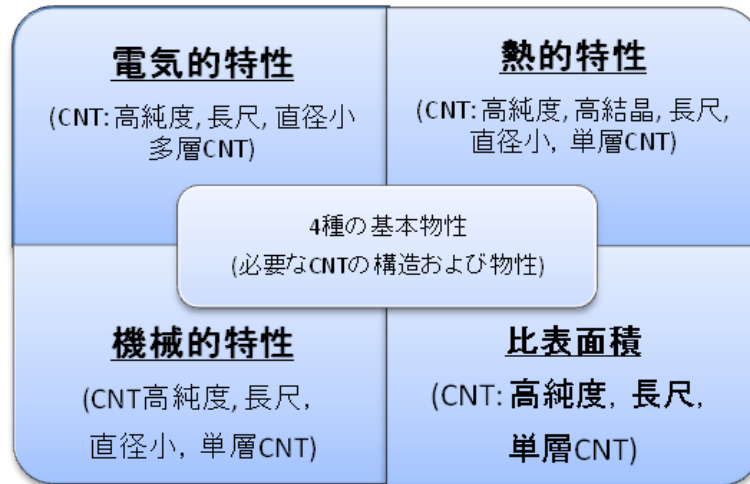
図 2.2.1.4.2-7 4つの基本特性に対応するCNT構造
