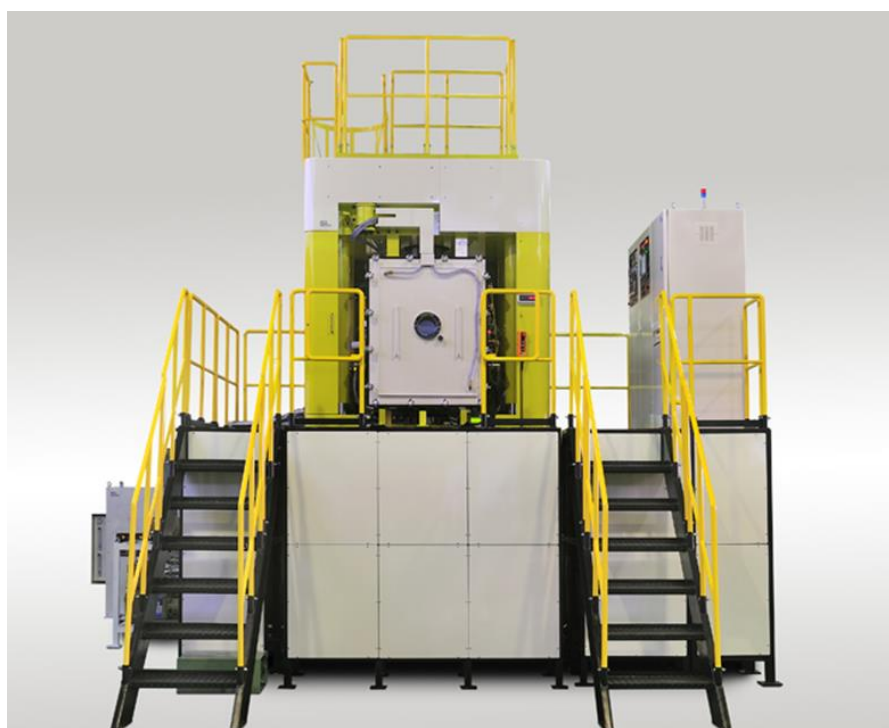
図2.3.2.1-13(b) 大型放電プラズマ焼結装置外観 (代表)
