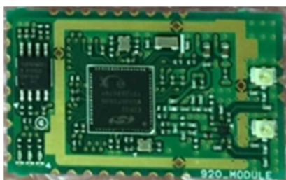
図Ⅲ-【①-1】-17 無線モジュール写真
