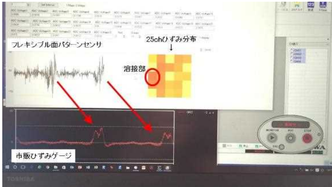
図Ⅲ-【①-1】-13 フレキシブル面パターンセンサによる阪神高速鋼橋のひずみ分布評価実証試験
