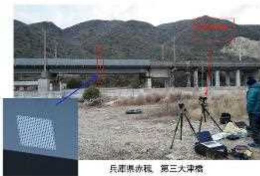
図Ⅲ-【②-2】-7 新幹線橋りょうの計測の様子
