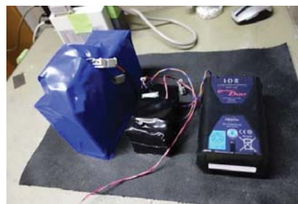
ロボット用バッテリーで動作する200kV X線源
