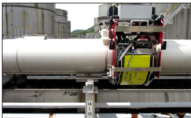
図 III-【③-(2)】-5 フィールド試験中の中性子水分センサ搭載ロボット
