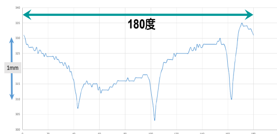
図III-【③-(2)】-7 X線による外径計測の角度依存性
