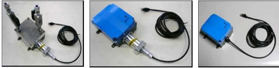
原理試作1 (乾燥封止) 原理試作2 (気密封止) 現状品 (比較サンプル)
