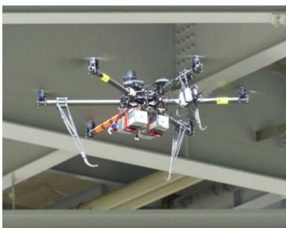
図Ⅲ- 【③-(1)-2】 -1 点検ロボット
