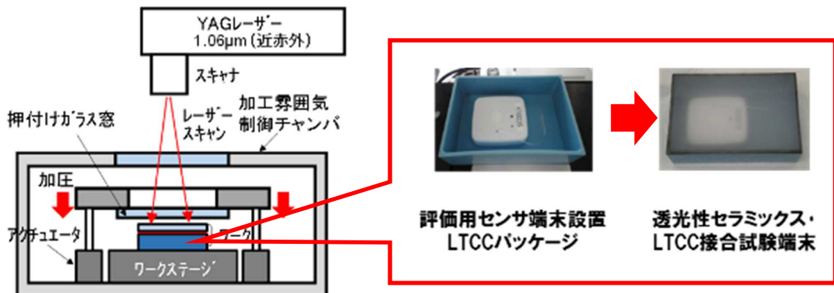
図Ⅲ-【①-1】-37 YAG レーザによるパッケージ封止実装プロセス
