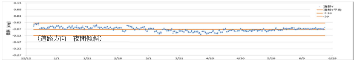
図Ⅲ-【①-1】-23 情報板 夜間傾斜時系列トレンド (頂部道路方向) 2015/12/17~2016/6/4
