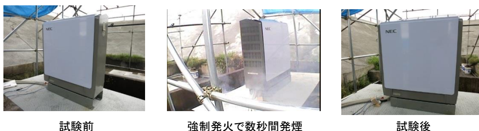
図Ⅲ-27 ゲルポリマーセルを搭載した小型蓄電システムの耐類焼試験
