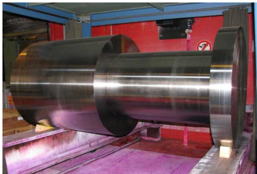
大型ロータの試作(重量:14ton) 東芝開発材 Ni基合金TOS1X-II *注1)
