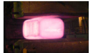
図 鍛造製造(鍛伸)
