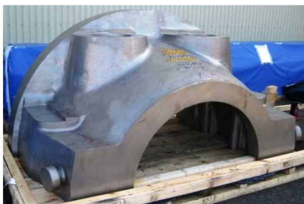
大型ケーシングの試作(重量:9ton) Ni基合金IN625
