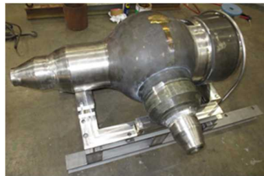
図 49 タービンバイパス弁（ボイラ起動弁）
