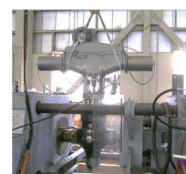
弁組込耐圧試験
