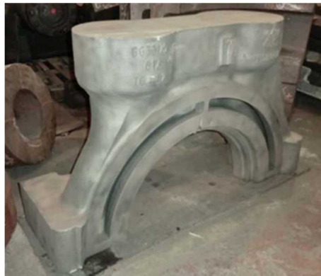
図 35 鑄造ノズルボックス
