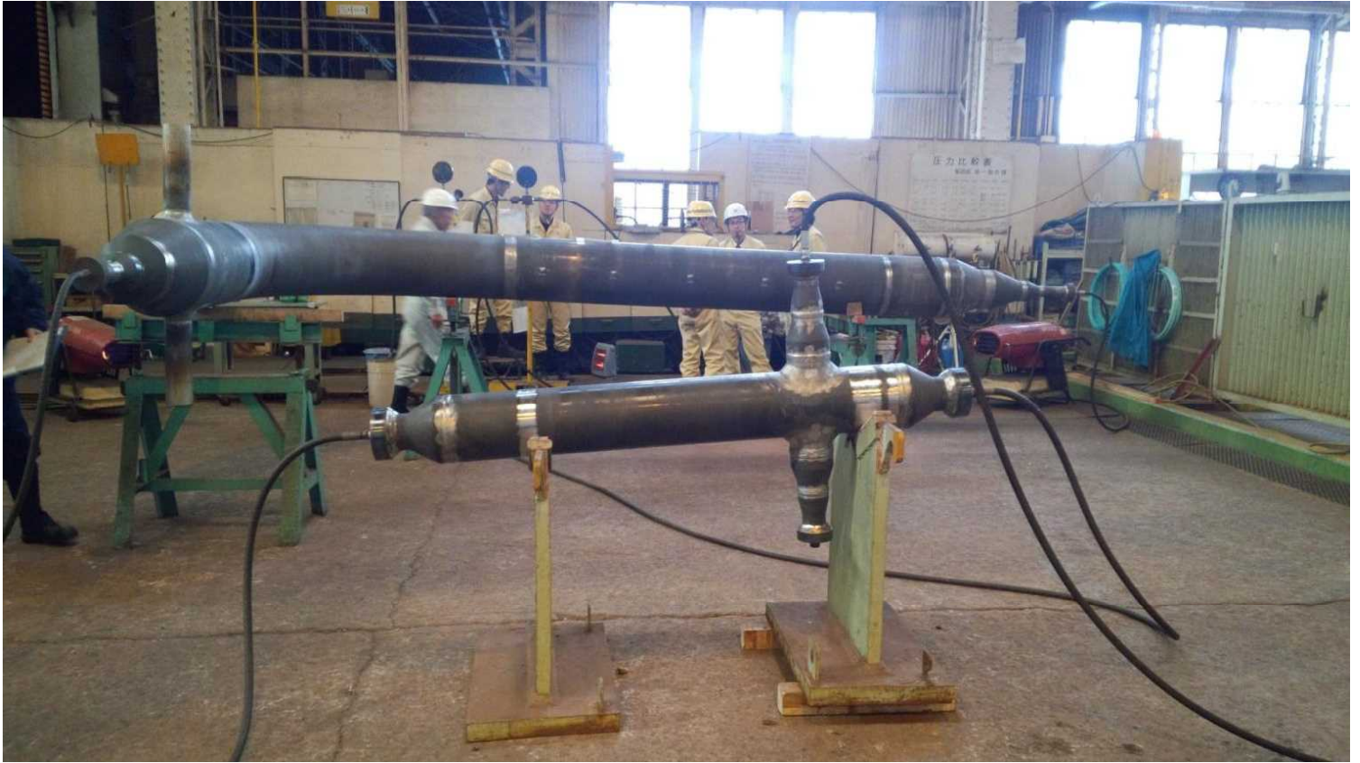
工場内耐圧試験状況
