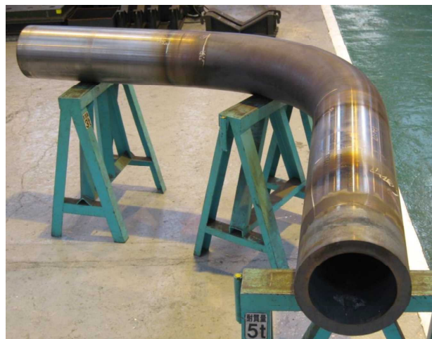
曲げ後の外観
