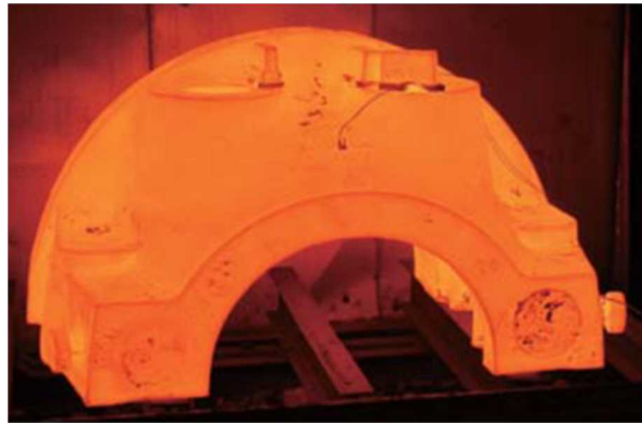
図 34 鑄造内部ケーシング
