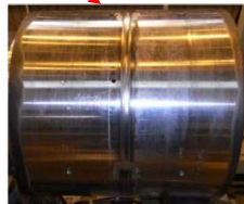
ロータ溶接 モックアップ試験
