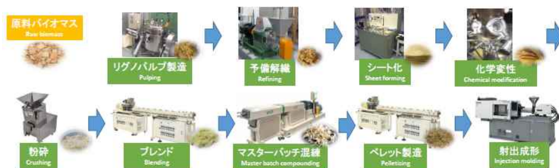
図Ⅲ-2.2.1-26 本研究で開発した一貫製造プロセス：京都プロセス
