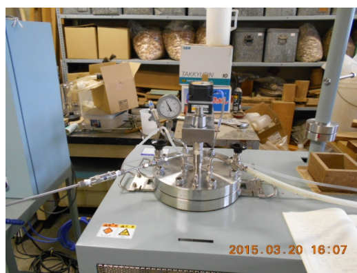
図Ⅲ-2.2.2.7-8 酸素アルカリ蒸解用オートクレーブ（左：断面図、右：外観写真）
