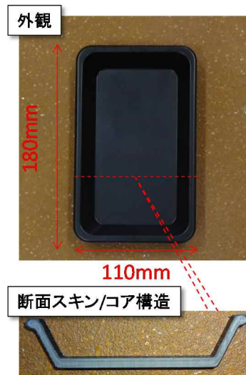
図Ⅲ-2.2.1-25 スケールアップ成形品 (トレイ) の外観及び断面
