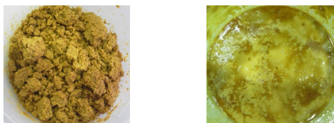
図Ⅲ-2.2.2.4-4 アセトン/水-木粉スラリー（固形物：20%） 左：カッティングミル（0.2 mmふるい）、右：ボールミル処理（0.1 mm）
