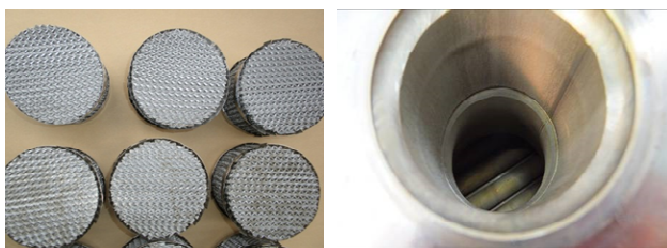
図Ⅲ-2.1.2-22 粗フルフラーール精製時の塔内部の確認例
