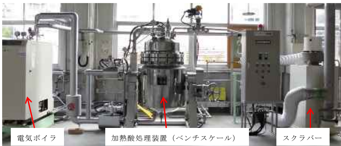
図Ⅲ-2.1.2-1 ベンチスケール設備 (200 L 加熱酸処理装置)
