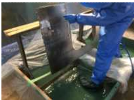
図Ⅲ-2.3.5-5 試作側構体パネルへの適正化表面処理手法の適応
