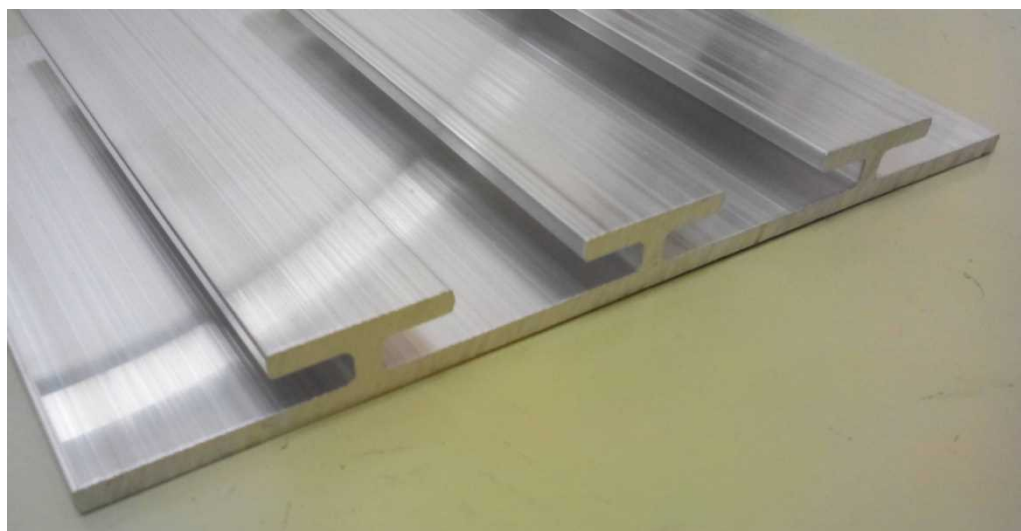
図Ⅲ-2-3.4-1 AX92 合金のシングルスキンパネル型材写真
