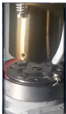
図Ⅲ-2.1.2-25 試料Aへ熔融亜鉛を滴下した際の液滴
