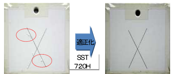
図-III-2.3.5-3 SST での糸錆改良
