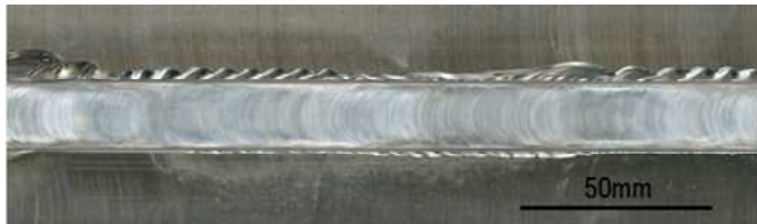
(a)接合材の外観写真（接合深さ 6mm 超）
