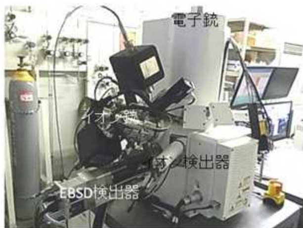
図Ⅲ-2.1.2-7 電子銃,イオン銃,各検出器の配置
