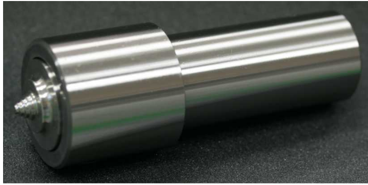
図Ⅲ-2.7.8-6 試作した FSW ツール外観写真
