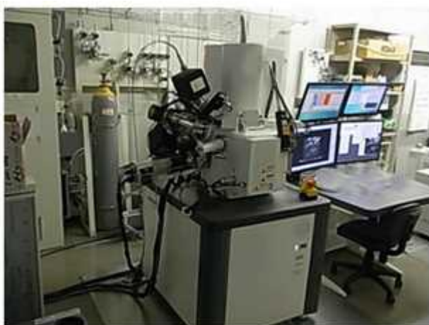
図 III-2.1.2-5 開発されたその場観察装置の外観（本体部）
