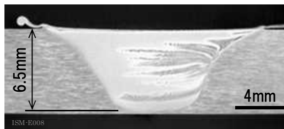
(b) 接合部断面写真（接合深さ 6mm 超）
