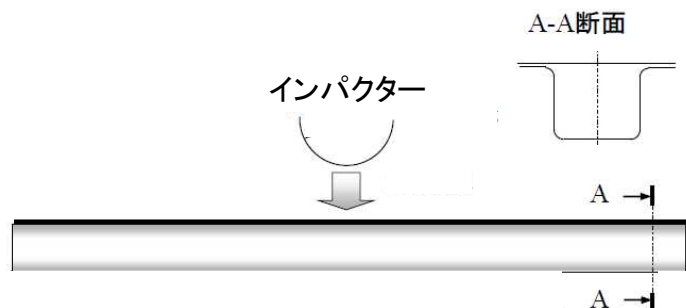
図Ⅲ-2.7.3-14 衝撃三点曲げ試験の模式図
