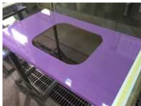
図Ⅲ-2.3.5-5 試作側構体パネルへの適正化表面処理手法の適応
