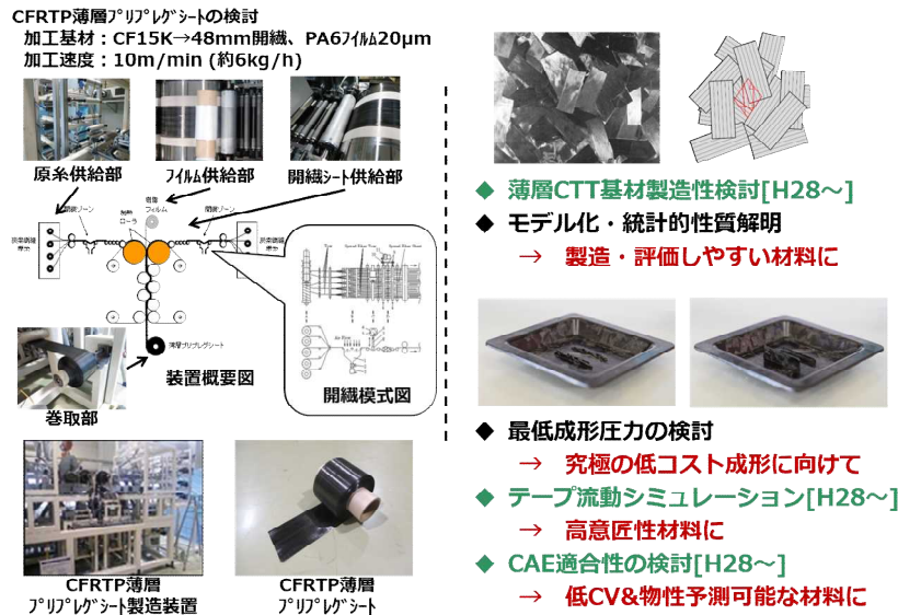
図Ⅲ-2.6.2-21 中間基材（薄層テープ系）
