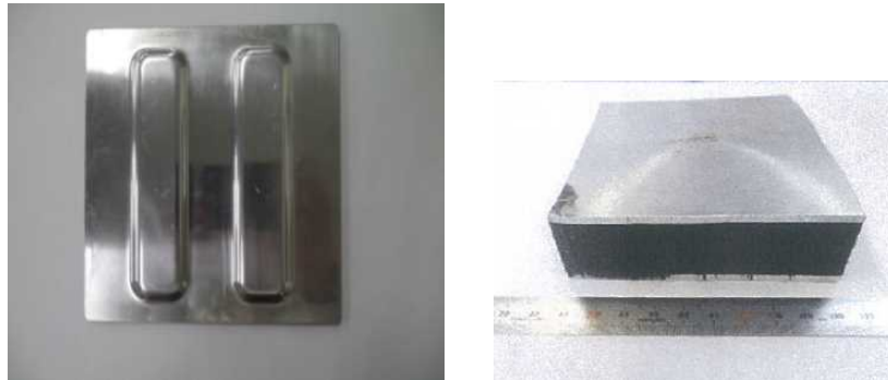
図Ⅲ-2.6.2-17 アルミ/CFRTP 一体成形品
