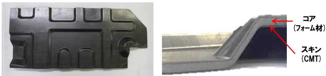
図Ⅲ-2.6.2-18 CMT を用いたサンドイッチ成形体
