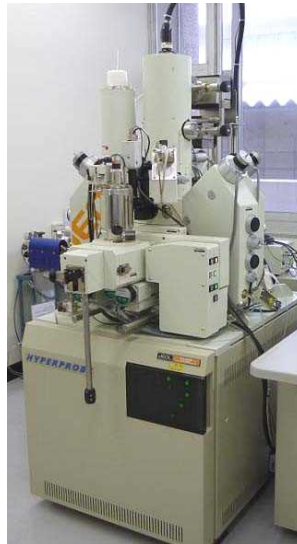
図Ⅲ-2.1.3-3 炭素分配分析用 FE-EPMA の外観
