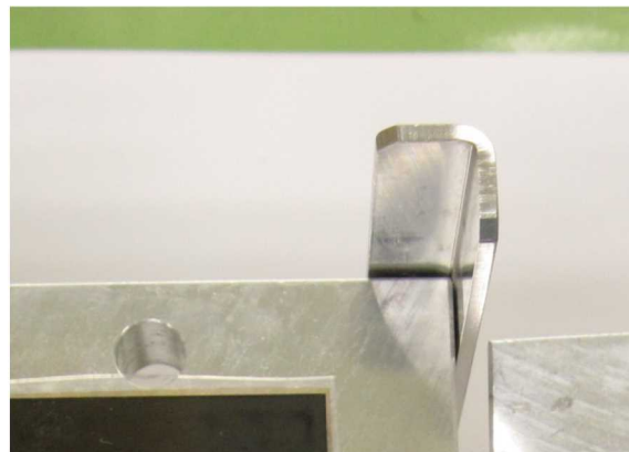
図 22 発電試験後のセパレーター（分
