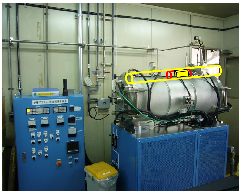
図2. 4. 2-44 超高温（3200°C）での熱処理が可能なタンマン炉
