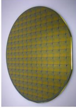
CVD法で基板サイズに成膜したグラフエーを用いたトランジスタ (出典：株式会社富士通研究所)
