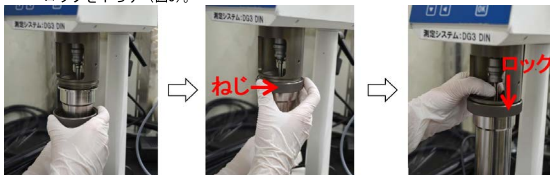
図3 スピンドルを差し込んだサンプルホルダーを粘度計に装着する流れ
