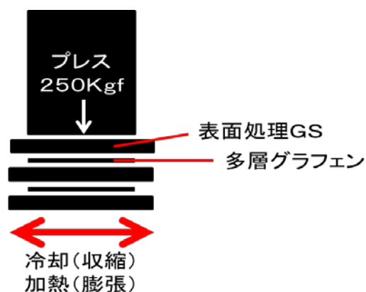
図2. 4. 2-33 超高温プレス処理による平坦化実験の概要
