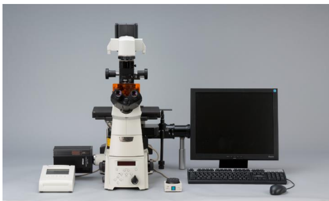
図 2.5.1-1 基となる白色TIRF顕微鏡.
