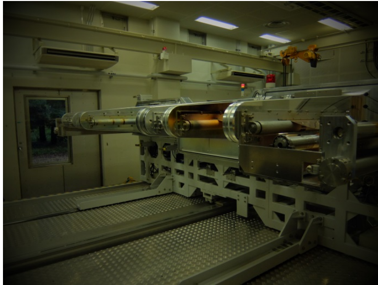
図 2. 4. 1-15 GR1000 型機のハッチ側の三室の仕切り隔壁および作動排気部の状況
