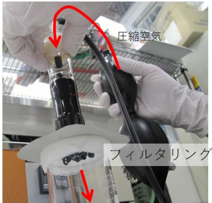
図2.3.2-7 CNTペースト用フィルタリングプロセス
