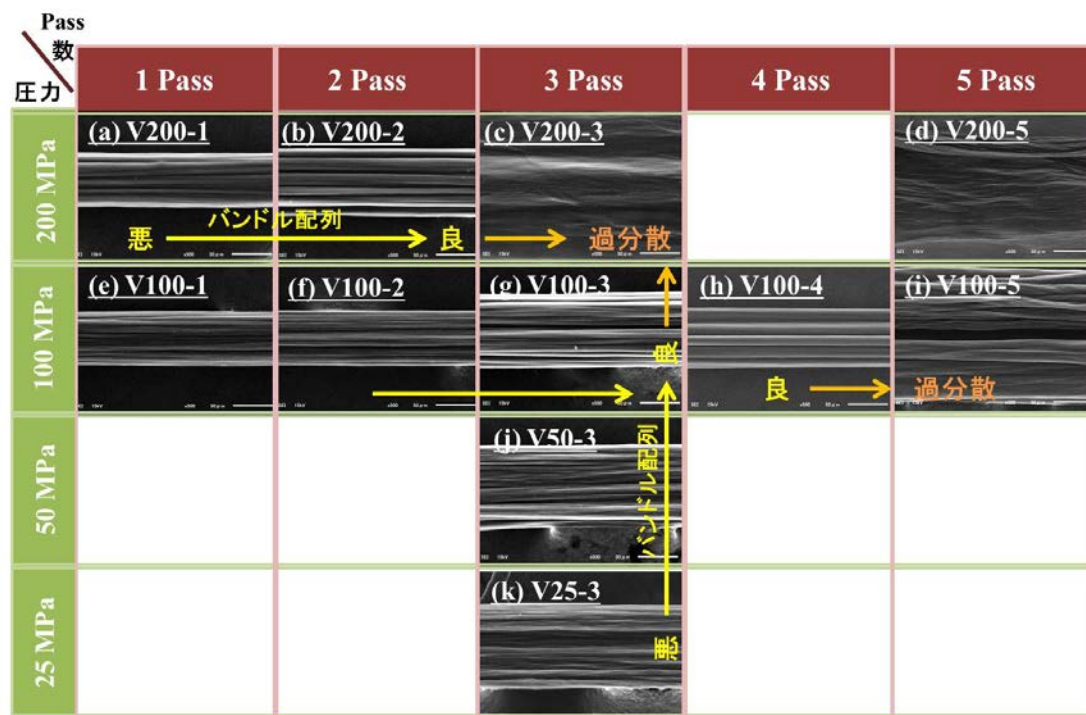
図 2. 2. 6-19 ナノヴェイタの分散条件を変更した e D i p s 分散体を用いて作製した e D i p s ファイバーの SEM 写真
