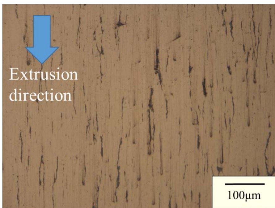
図 2.3.3-33 押出材組織写真 (低温押出, 炭素繊維 10 vol.%, 使用銅粉末径 45 μm)
