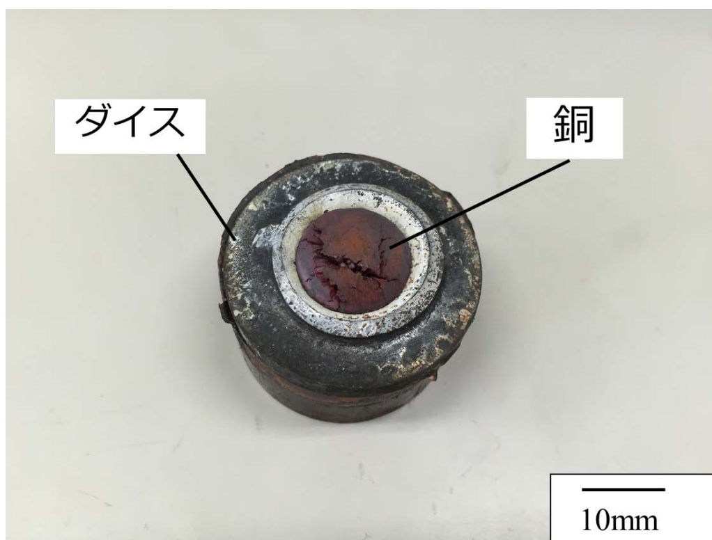
図 2. 3. 3-31 低温押出後ビレット (Al 潤滑剤なし)
