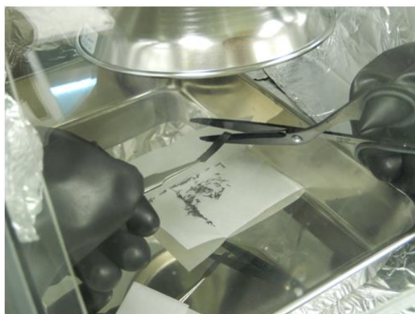
図 2.1.1-11 剥離グラフェンの集積膜の切断試験の概要
