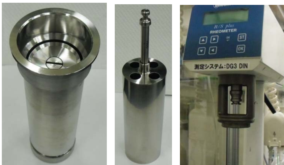
図1 サンプルホルダー（左）とスピンドル（真中）、それらを装着する前の粘度計（右）
