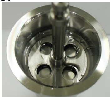
図2 スピンドルを差し込み溶媒を投入したサンプルホルダー上部
