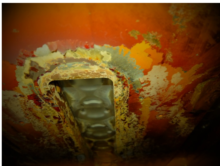
図2. 4. 1-14 GR1000型機の成膜室に装備したマイクロ波ランチャーの石英窓および周辺の状況
