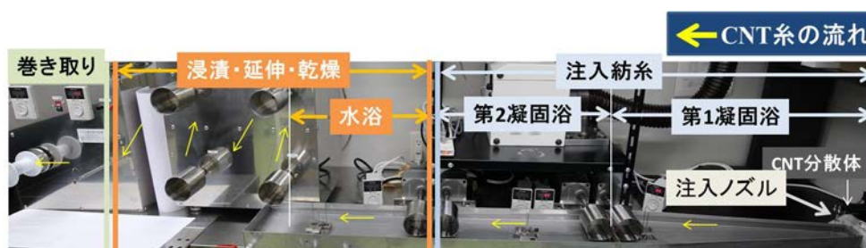
図2. 2. 6-23 CNT連続紡糸装置概要
