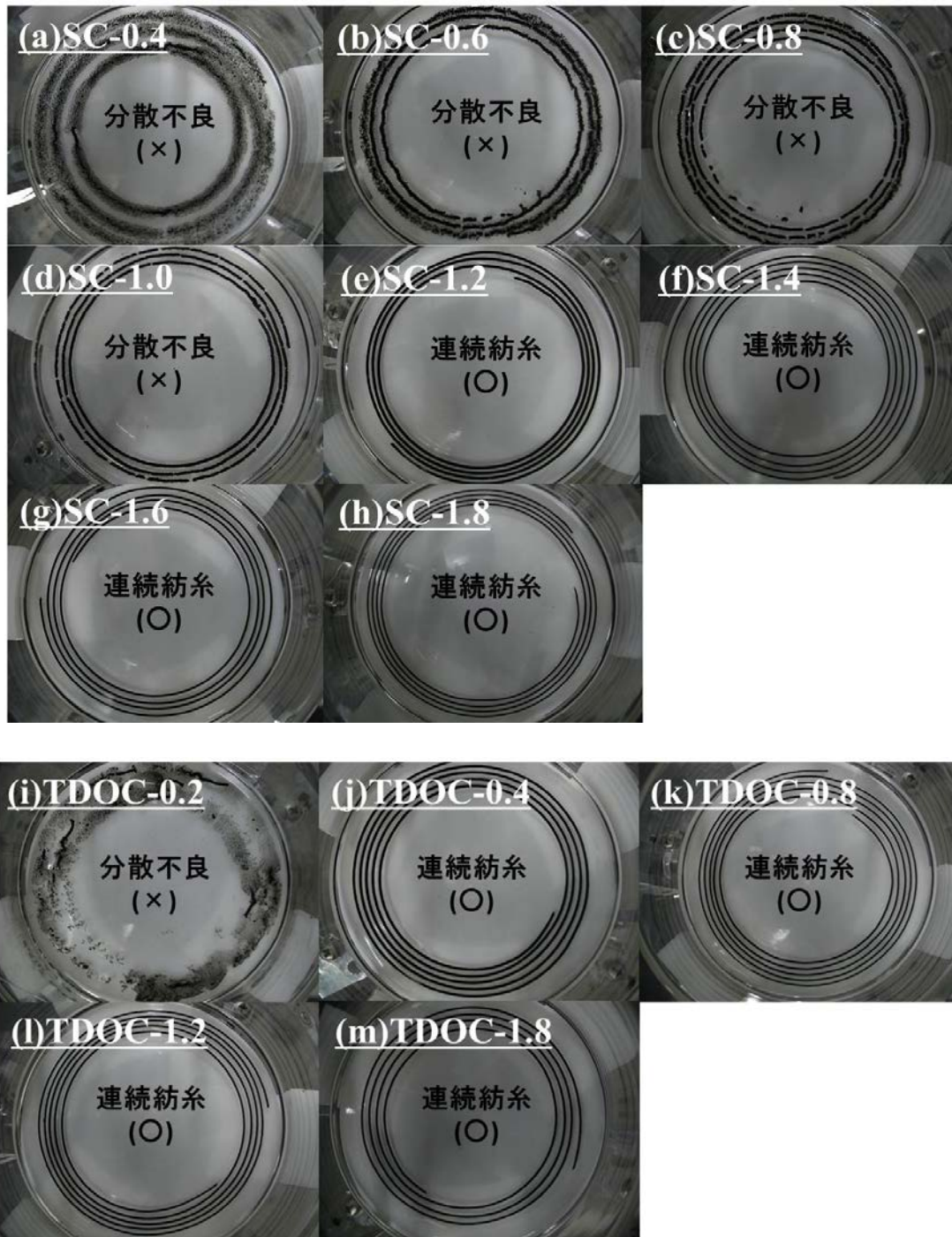
図2.2.6-8 界面活性剤濃度を変更したSG-CNT分散体をIPAに注入紡糸した直後のSG-CNTファイバーの写真((a)-(h);界面活性剤種SC, (a)0.4 wt%, (b)0.6 wt%, (c)0.8 wt%, (d)1.0 wt%, (e)1.2 wt%, (f)1.4 wt%, (g)1.6wt%, (h)1.8wt%, (i)-(m);界面活性剤種TDOC, (i)0.2 wt%, (j)0.4 wt%, (k)0.8 wt%, (l)1.2 wt%, (m)1.8 wt%
