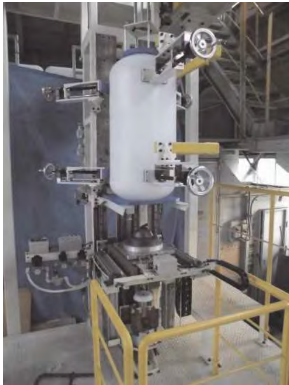
図 9 新型 縦型融着機 融着状況
