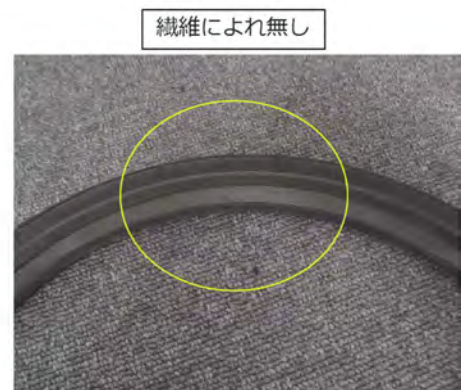
図 35 30L 改良した CFRP 補強
