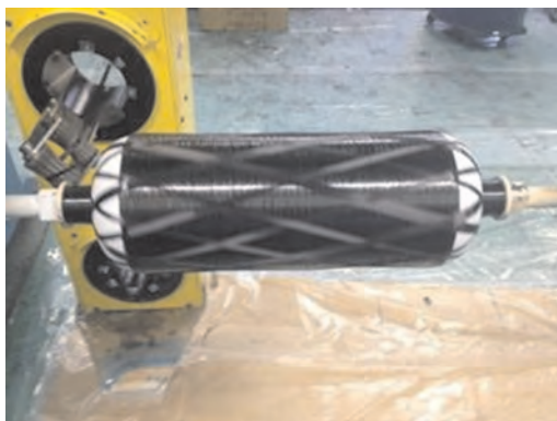
図10 新TPP-C 7.5L容器 破裂試験後
