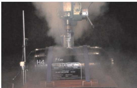
図 3.9 CFRP 容器の穴あけ時状況
