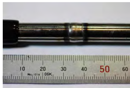
図 3.25 内圧模擬疲労試験に供した溶接配管
