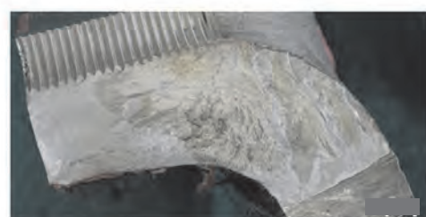
図5 中型容器 A (50~90%試験後) 漏洩部破面
