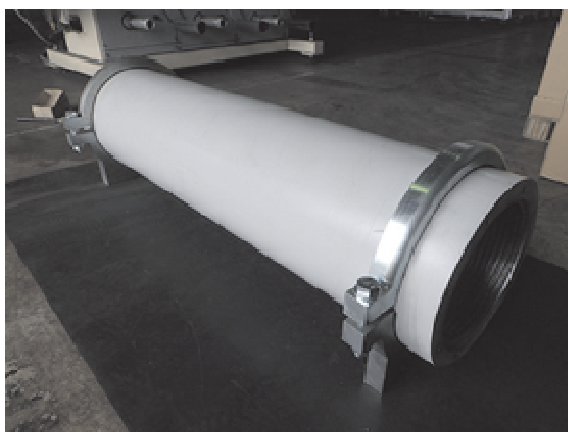
Fig. 35 防錆塗装 ( 白 ) が施された鋼材ライナー ( 両端にハンドリング治具 )
