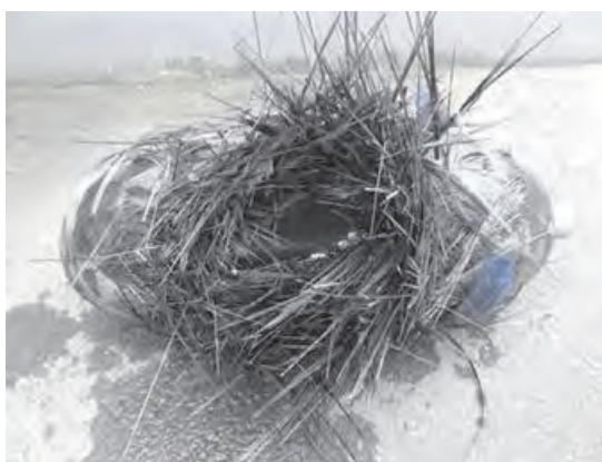
図11 新TPP-C 7.5L容器 破裂試験後
