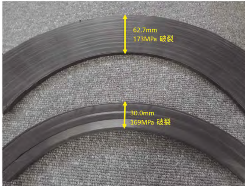
図 33 30L CFRP 補強層切断面
