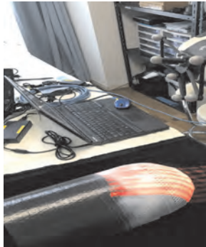
図8 可視光による表面形状の計測
