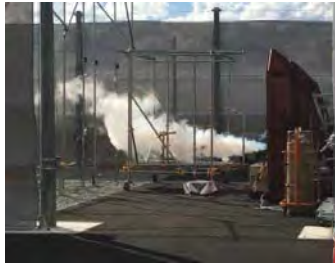
液化水素漏洩拡散実験の様子
