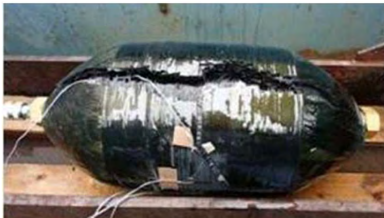
Fig. 2 薄肉ライナ (9.4 L 容器) (破裂圧力 59MPa) CFRP 層の破断とライナ破裂が同時
