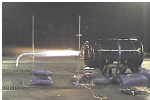
図 3.11 容器内の残留水素に引火試験 図 3.12 容器内の水素に引火した際の圧力変化
