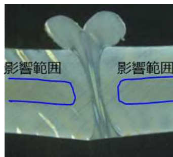
図3-14 溶着部水素曝露試験結果
