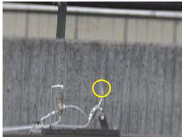
微小水素火炎の可視画像 (背景画像上への近赤外光差分画像と紫外画像の重ね合わせ)
