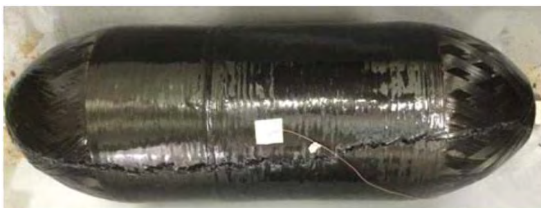
Fig. 4 厚肉ライナ (30 L 容器): 破裂圧力 (157 MPa)
