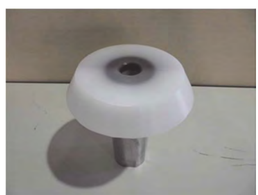
図 28 口金をインサートした口金ブロックの製作状況
