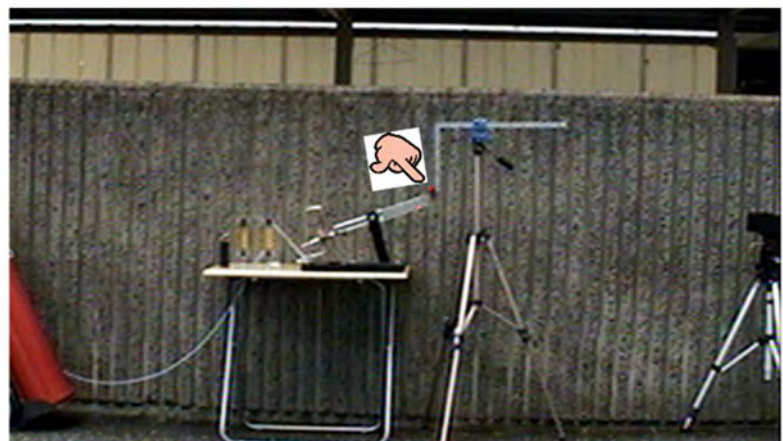
図 2 水素火炎可視画像(離隔距離 5m、火炎長 2cm)
