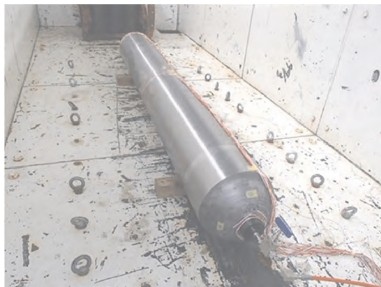
図3 試作ライナーの水圧試験状況
