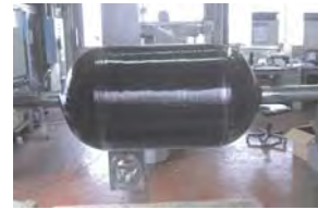
改良したFWプログラムによる試作容器(30L) （中国工業）
