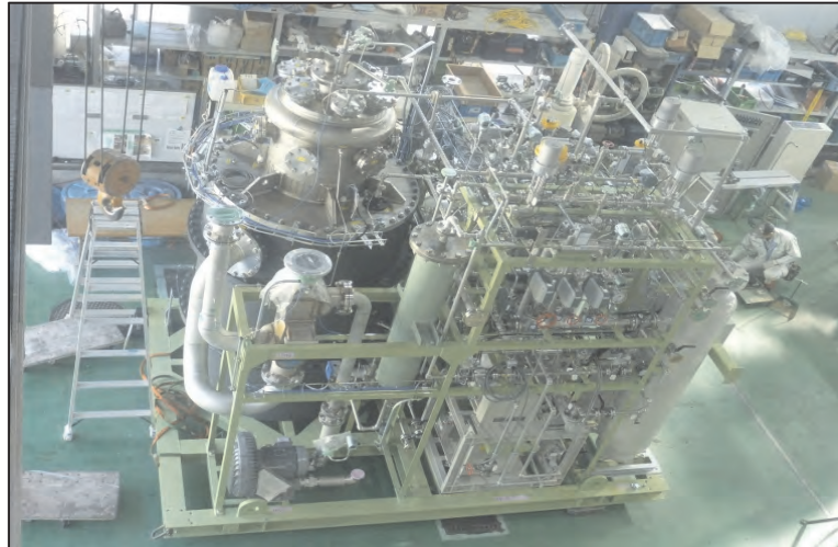
図 14 水素製造装置 ( 実証試験装置 )
