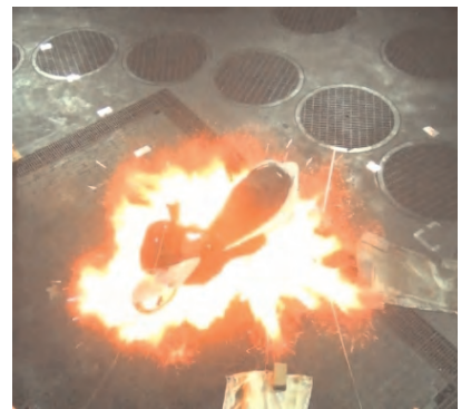
図 3.15 安全弁作動時の状況
