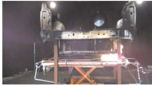
図 3.4 車載容器の局所火炎暴露試験
