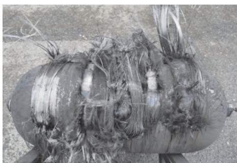
図 3.6 破裂直前に水冷させた容器
