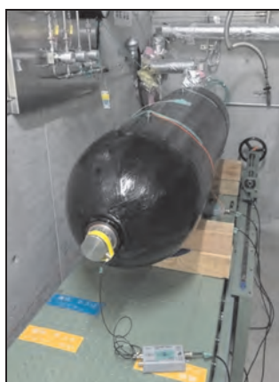
図 37 気密試験室でのガス流入実験
