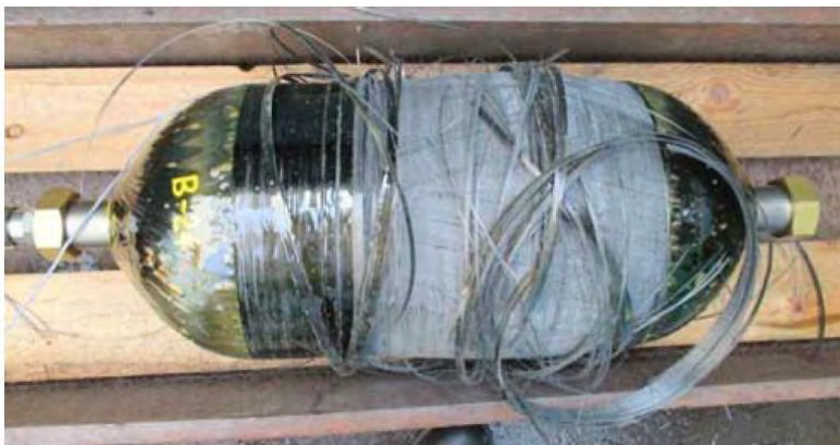
Fig. 3 厚肉ライナ (9.4 L 容器): 破裂圧力 (86 MPa)
