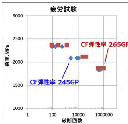
図 3-27 CFRP 疲労特性評価の結果
