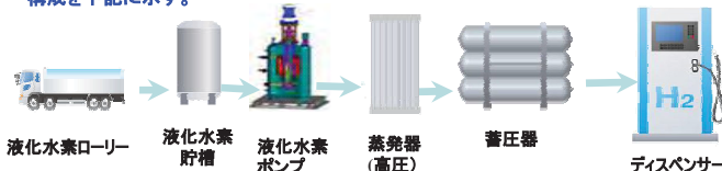
液体水素ポンプの導入を今回モデル構成に取り入れ検討を行った。
