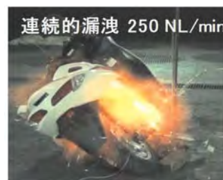
連続的漏洩 250 NL/min FC二輪車の水素センサー取付け要件に関わる水素漏洩試験
