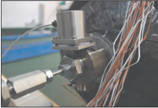
図 39 光ファイバ AE センサ設置状況
