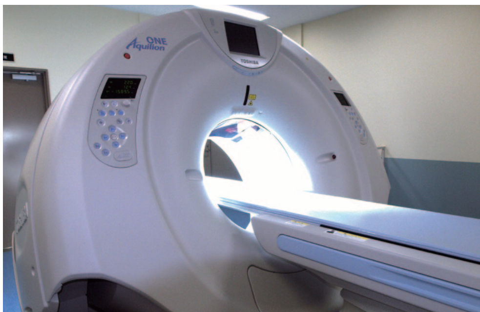
4次元X線CT装置「Aquilion ONE™」。ガントリ（回転部）は頭部撮影時などに角度調整ができる。
