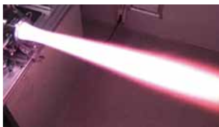
回転デトネーションエンジンの作動実験の様子 Rotating detonation engine combustion test
