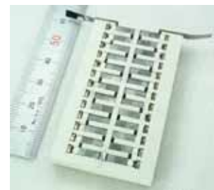
本研究により作製された 発電モジュール Power generation module fabricated by this project
