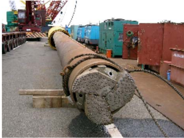
図Ⅲ.6.2-5 ダウンザホールハンマの先端部（牛腸ら, 2010）
