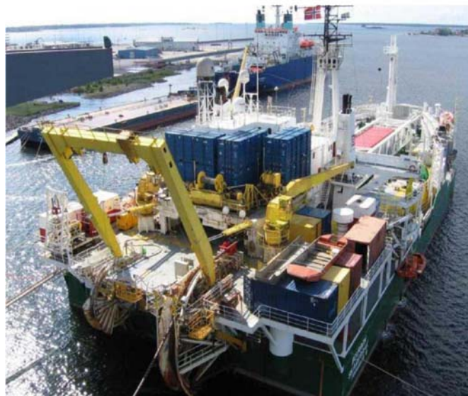
図Ⅲ.6.2-58 海底ケーブルの積み出し状況（日本産業機械工業会, 2010）
