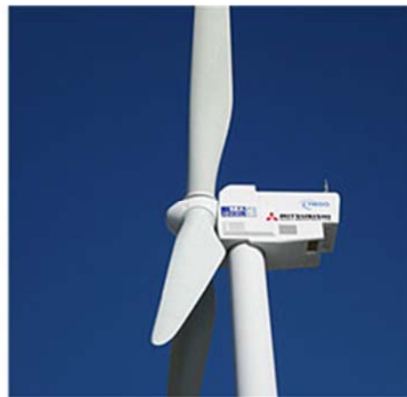
図-3 SEA ANGEL 三菱重工業 7.0MW（油圧ドライブ＋同期式発電機） （NEDO（2013）：洋上風力発電の取組）
