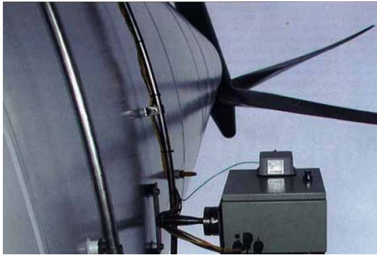
図Ⅲ.9.2-11 赤外線探知機の設置状況 (Desholm and Kahlert, 2005)
