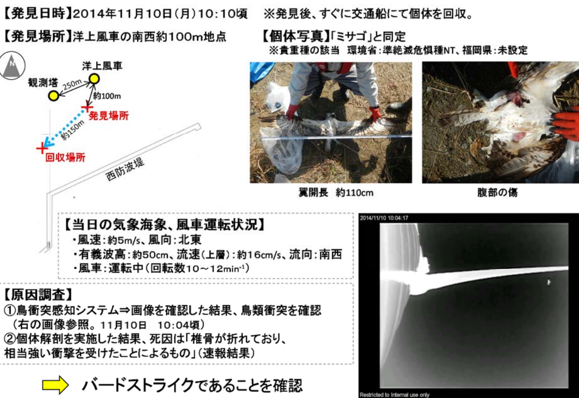
図Ⅲ.9.2-19 北九州市沖洋上風力発電施設におけるバードストライク
