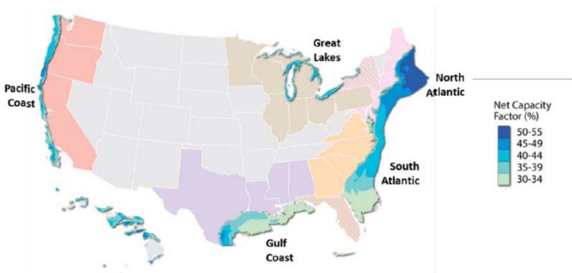
図 II.2.1-5 アメリカにおける洋上風力発電の設備利用率分布図 (Musial et al. , 2016)
