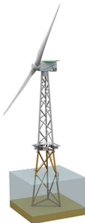
図-5 2B6 の 2 枚翼風車（6.0MW 機）
