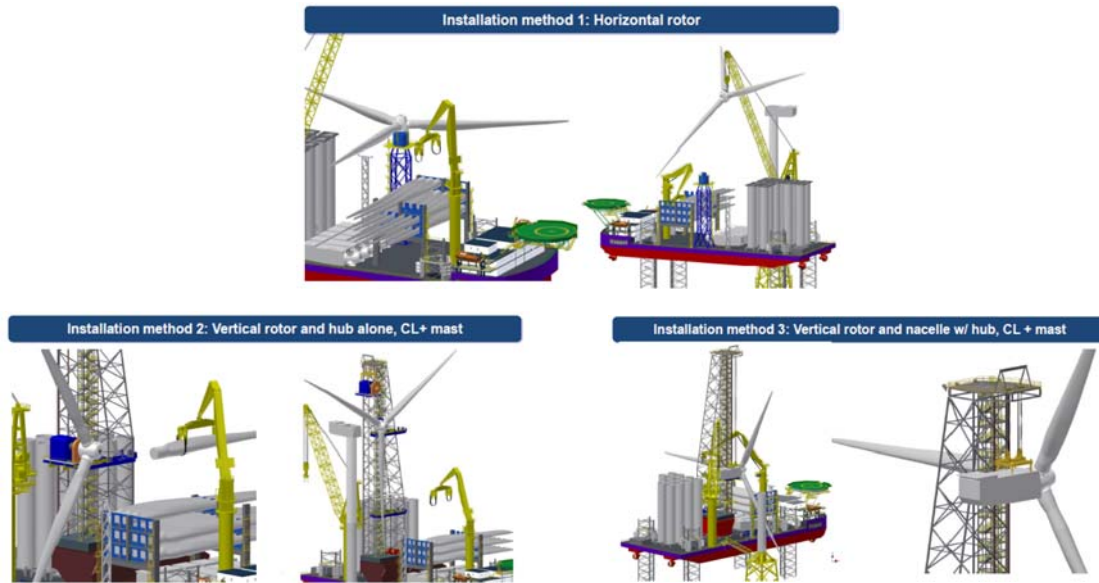
図Ⅲ.6.2-42 従来型（上図）と新提案（下図）の風車設置方法（Mortensen et al. , 2011）
