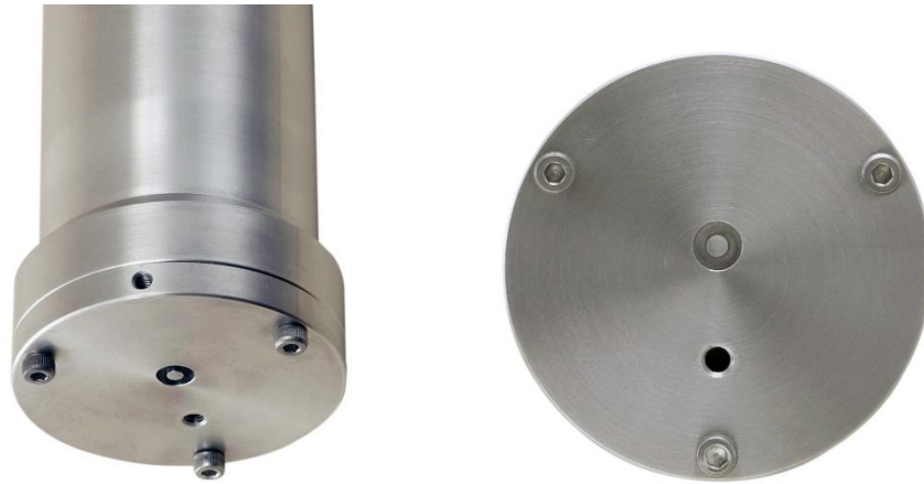
図Ⅲ. 3. 2-1 水圧式波高計 (INFINITY-WH) (JFE アドバンテック提供)
