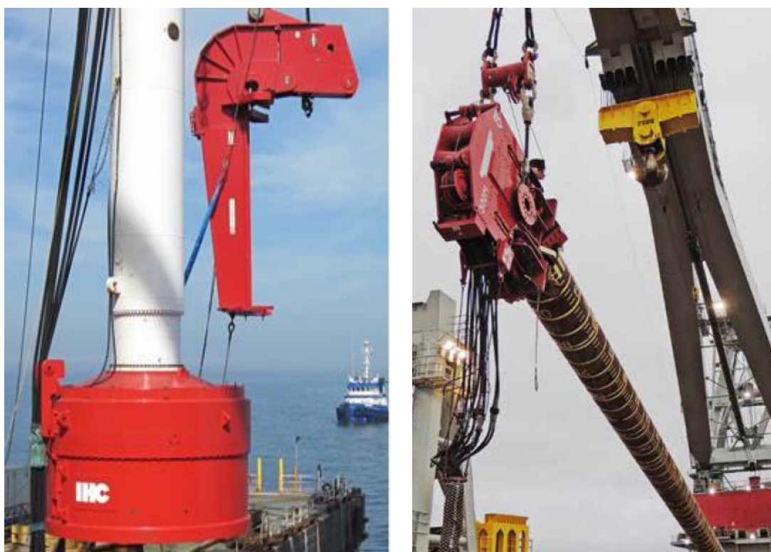
図Ⅲ.6.2-7 油圧ハンマとバイブロハンマの外観
