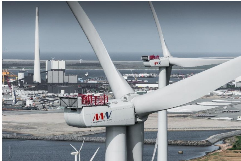
図-2 V164-8.0MW（同期式（増速機＋永久磁石方式） （MHI Vestas Offshore Wind A/S 提供）
