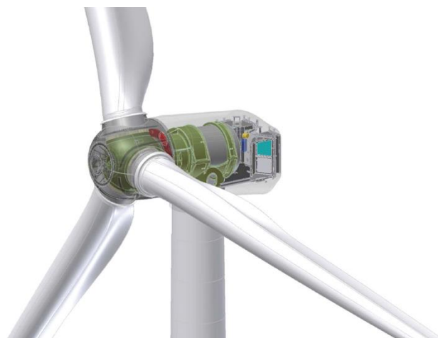
図-4 SeaTitan (American Superconductor) 10.0MW（超電導発電機）
