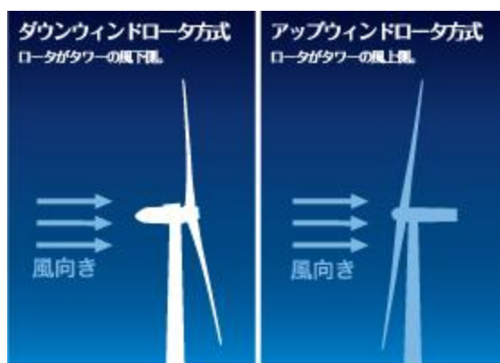
アップウィンドロータ方式とダウンウィンドロータ方式の相違
