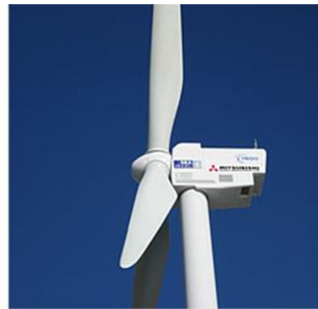
図-3 SEA ANGEL 三菱重工業 7.0MW（油圧ドライブ＋同期式発電機） （NEDO（2013）：洋上風力発電の取組）
