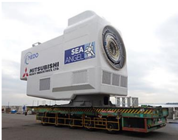
図-3 SEA ANGEL 三菱重工業 7.0MW（油圧ドライブ＋同期式発電機） （NEDO（2013）：洋上風力発電の取組）
