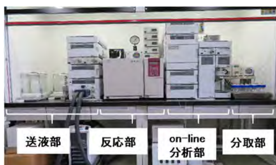
図 3-⑧-4 高温・高圧反应用小型フローリアクター装置(左)、及びフロー合成プロセスの概念図(右)
