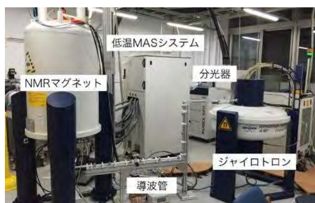
図 3-⑫-1 固体 DNP-NMR 装置
