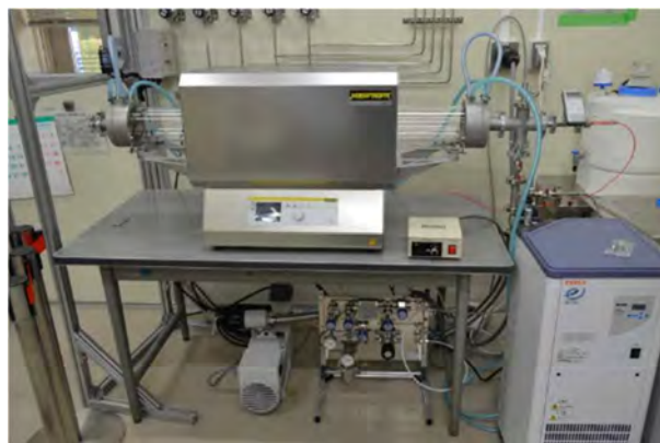
図 3-⑨-3-2 表面改質装置の外観
