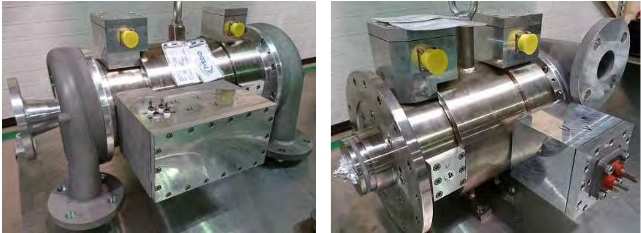
図 2.1.1-8 圧縮機・膨張機の外観（左：2 段圧縮機，右：膨張機一体型圧縮機）
