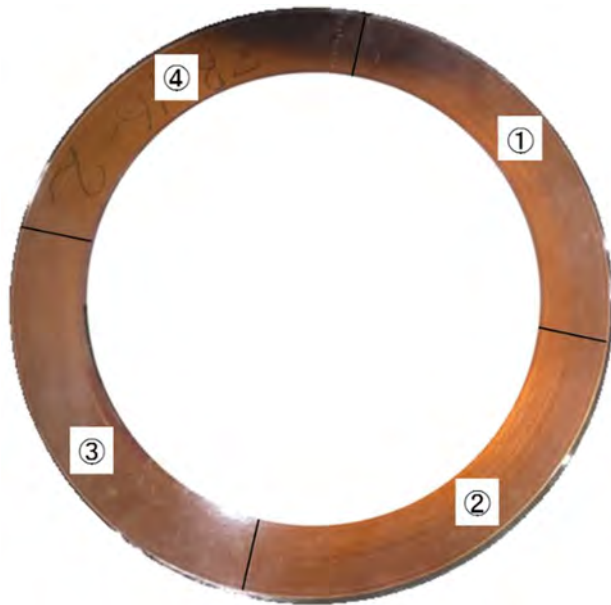
図 2. 2. 3-1 測定に用いた GdBCO 高温超伝導パンケーキコイルの外観
