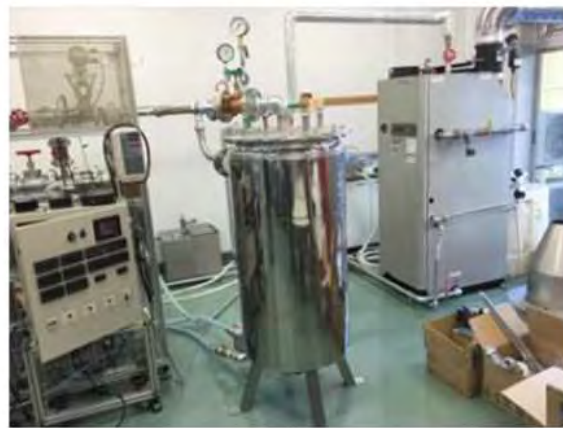
図Ⅲ(2.2)-2.設置した一次試作の気水分離器機
