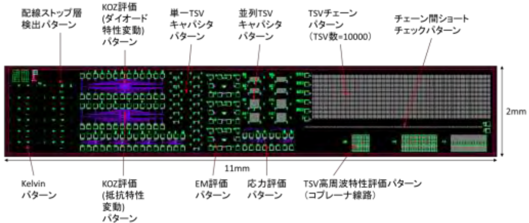
図Ⅲ-2.1.4-5 20\ \mu\text{m} ピッチ TSV 電気特性評価用チップ
