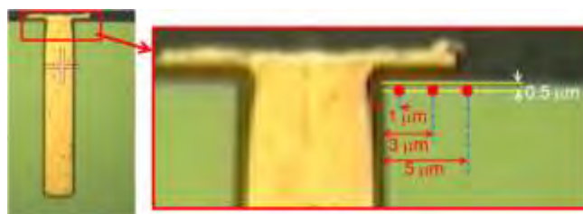
図Ⅲ-2.1.9-3-1 TSV サンプルの横断面
