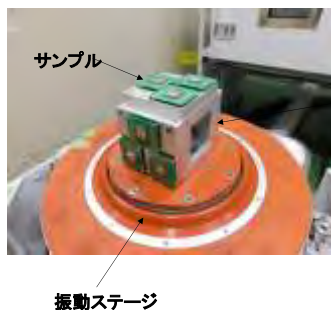
(a) 振動試験へのセット状態 (b) 詳細な振動試験条件
