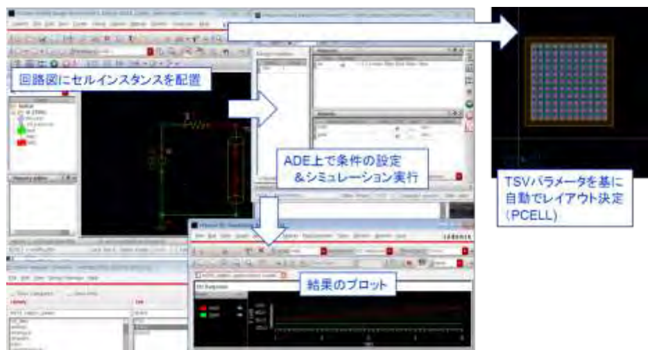
図III-2.1.3-44 回路図エディタ入力から TSV セルレイアウトの生成まで
