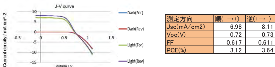
図 1.1.2.2-9 濃度 30%で作製した素子の特性(再現実験)
