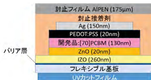
図 1.1.3.2.2-13 フレキシブル基板素子の構造
