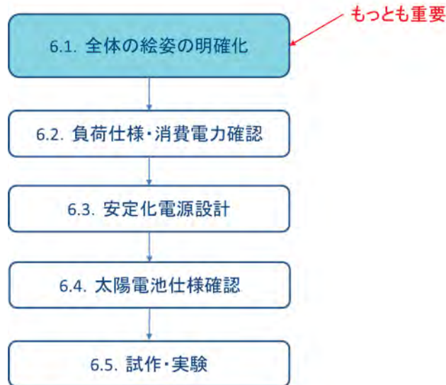
図 1.2.2.6.6-1 システム設計の手順 フロー図
