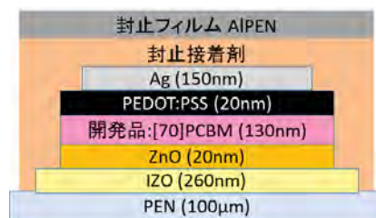
図 1.1.3.2.2-14 本試験に用いた素子構造
