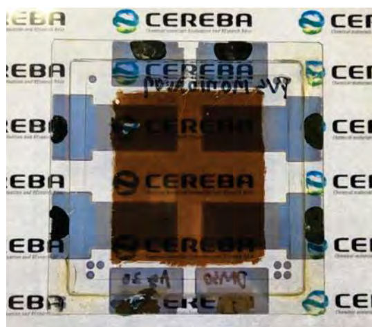
図 1.1.2.5-21 作製した半透過型素子
