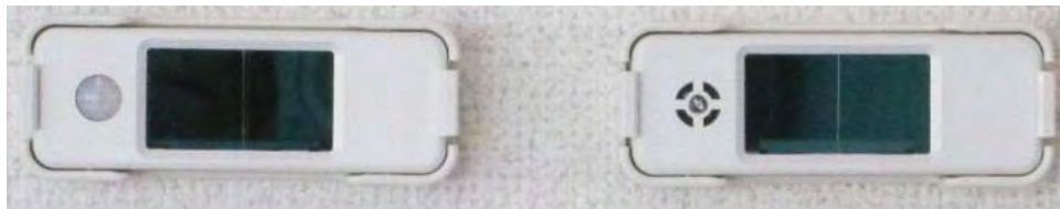
図 1.2.2.4-1 OPV 搭載人感センサー（左）と照度センサー（右）。
