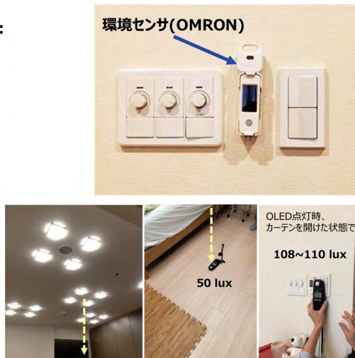
図 1.2.2.5-2 居住空間でのセンサ設置位置と照明の調光
