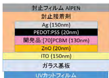
図 1.1.3.2.2-3 ガラス基板素子の構造
