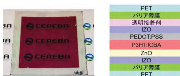
図 1.2.2.2-1 OPV シートの写真および断面構成図
