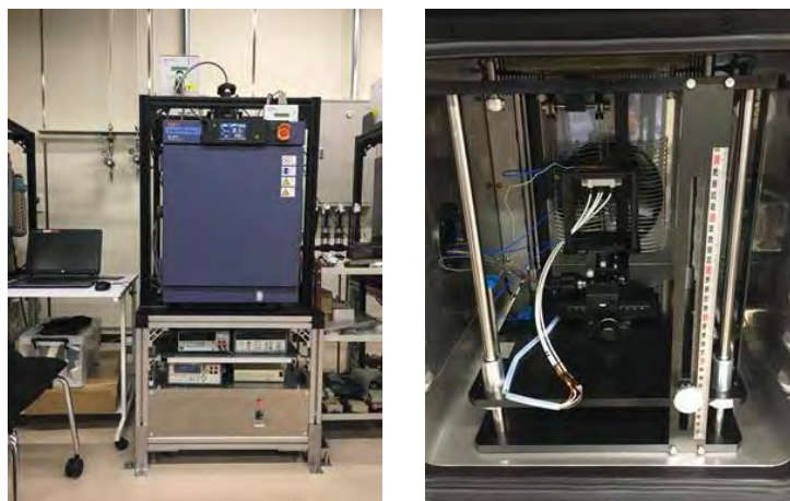
図 1.2.1.2-1 Multi-SUN 評価装置 (左：評価系全体、右：恒温槽内部)
