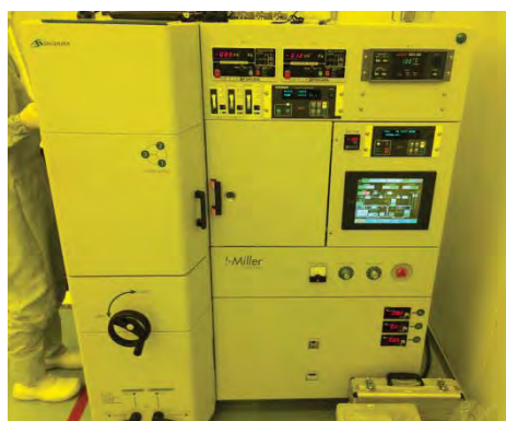
図 1.1.2.5-2 使用したスパッタ装置
