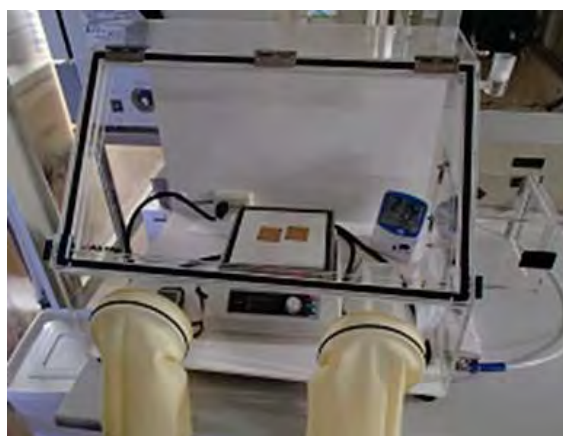
図 1.1.2.2-24 湿度コントロールグローブボックス
