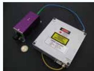
ファイバーレーザー光源と波長変換器 KEOPSYSレーザー光源(右)とオキサイド社波長変換器(左)
