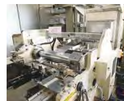
電極スラリーを薄くかすれないように高速で塗布する電極塗工装置。
