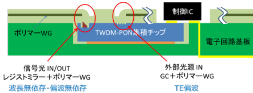
図Ⅲ-2.2.3(f-2)-5 TWDM-PON ONU 用光電子集積インターポーザの基本構造
