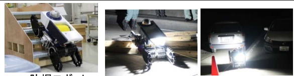
防爆ロボット 実在トンネルで深夜に実施した実証実験
