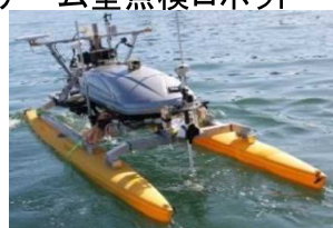
河川点検ロボット
