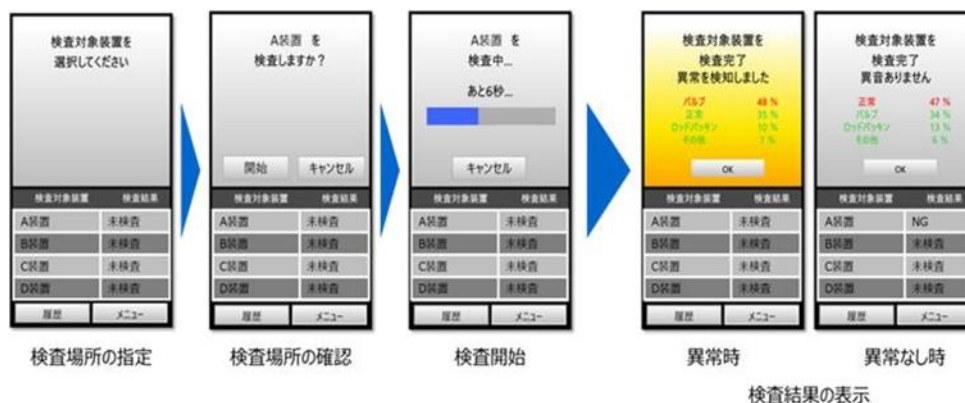
図 10 設備異常検知システムの画面イメージ
