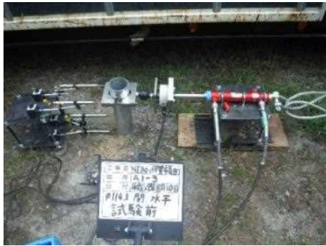
図III-2-④-(3)-6 水平載荷試験状況
