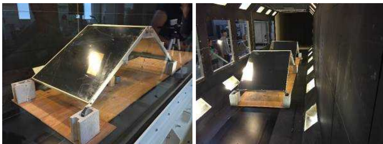
図Ⅲ-2-①-(3)-12 実物大モデルでの風洞実験
