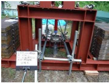
図III-2-④-(3)-4 押込載荷試験状況
