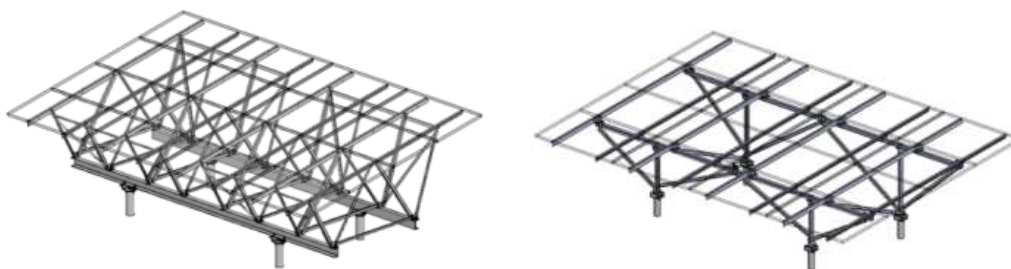
図Ⅲ-2-①-(5)-4 架台構想図（上：従来工法，下：新架台案）
