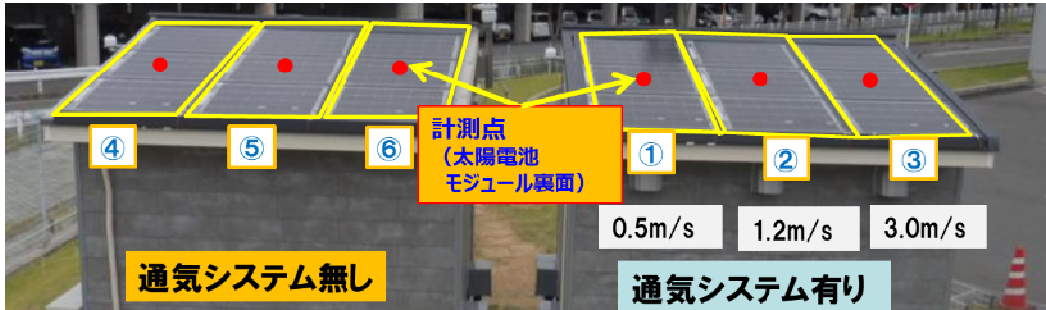
図Ⅲ-2-①-(6)-11 実寸サイズの通気システムによる冷却検証
