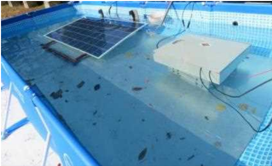
図Ⅲ-2-④-(2)-2 水没実験の様子（左：単体実験、右：システム実験）
