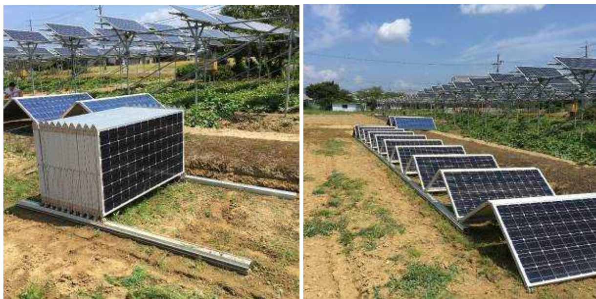
図Ⅲ-2-①-(3)-9 開発した折りたたみ架台
