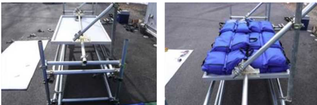
図Ⅲ-2-①-(2)-13 砂袋式荷重試験 負荷重の静荷重状態 2401Pa
