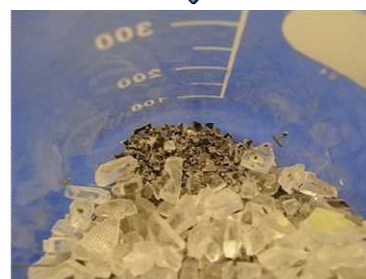
図Ⅲ-2-②-(4)-11 使用済み太陽電池モジュールから回収された金属およびシリコン
