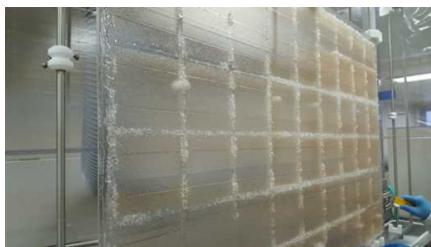
図Ⅲ-2-③-(2)-2 剥離剤浸漬後の使用済み太陽電池モジュール
