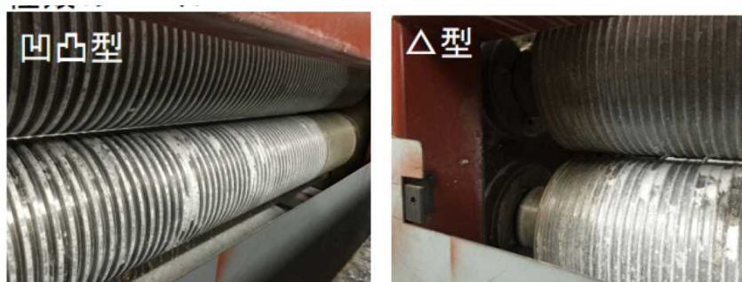
図Ⅲ-2-②-(3)-5 ロールの形状(左：凹凸型、右：△型)
