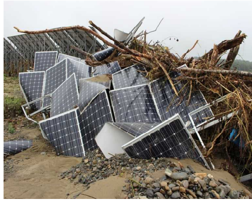
図Ⅲ-2-③-(4)-13 自然災害により被害を受けた太陽電池モジュール (※日経 BP 社 https://tech.nikkeibp.co.jp/dm/atcl/news/16/083011447/?ST=msb から引用)
