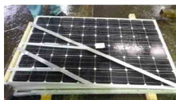
変形・破損なし
