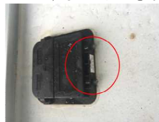
端子から導線が切断 されている様子
