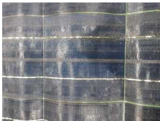
図Ⅲ-2-②-(4)-6 分離後の EVA/セルの受講面側写真
