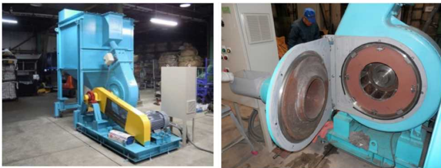
図III-2-②-(3)-8 遠心風力式破碎機 (左：外観、右：内部)
