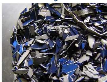
図Ⅲ-2-②-(4)-10 新しい太陽電池モジュールから回収された金属およびシリコン
