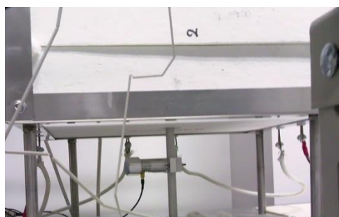
図 3-6-4.7 模擬単セル試験用電気炉下部のガス導入管に設置した AE センサ
