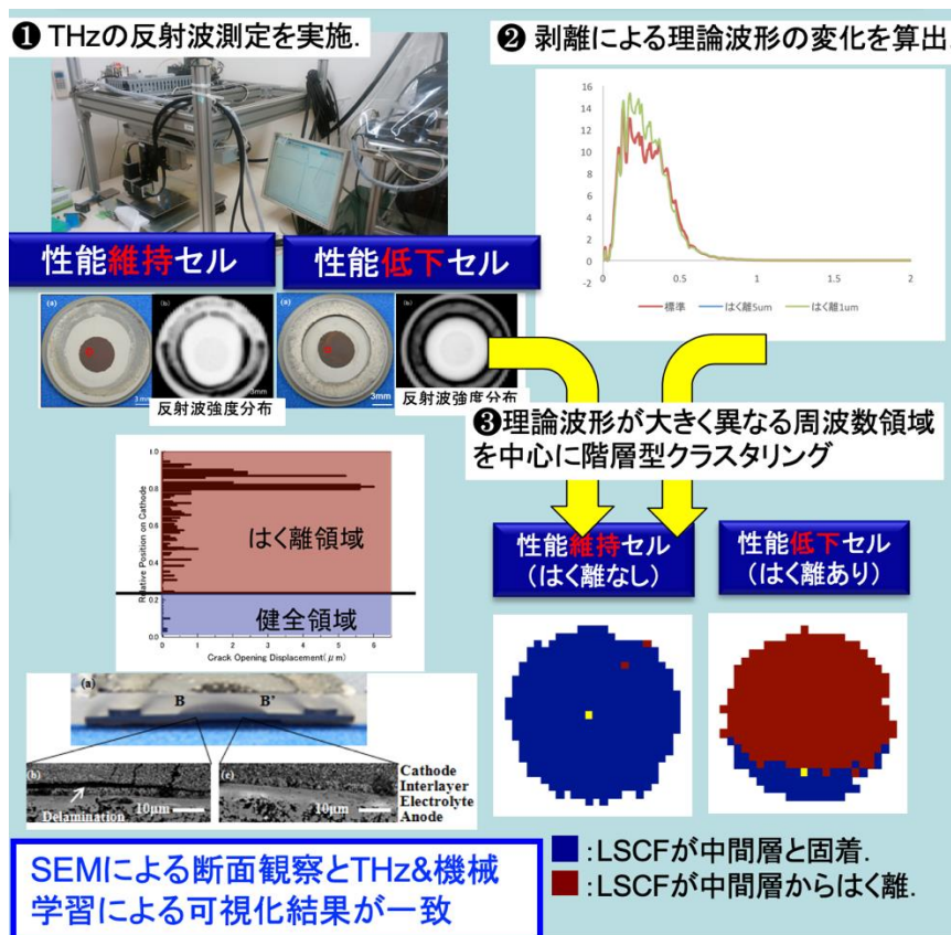
図 3-9-2.2 はく離現象の可視化 (テラヘルツ) 茶色 : はく離部分、青色 : 密着部分 (b) 断面観察によるはく離領域観察
