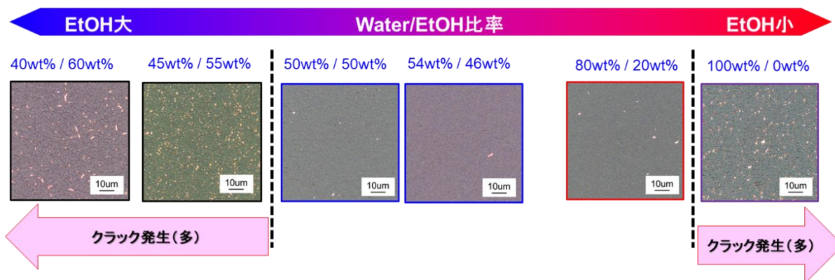
図1-1-3-1-3 インク溶媒のWater/EtOH比が触媒層クラックに及ぼす影響 (光学顕微鏡透過像×5倍 観察結果)
