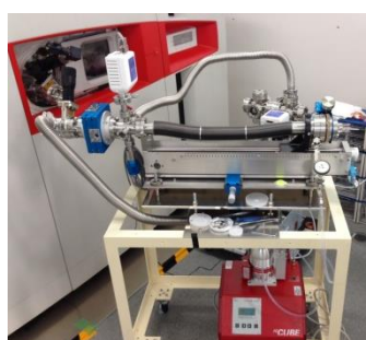
(左図)硫黄種の電位依存吸着構造を決定するための表面 X 線散乱測定システム。
