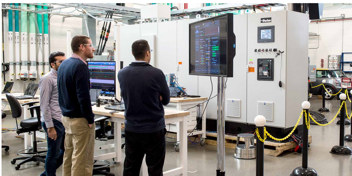
図 2-34 NREL のインバータ連系試験装置 [DOE のホームページから]
