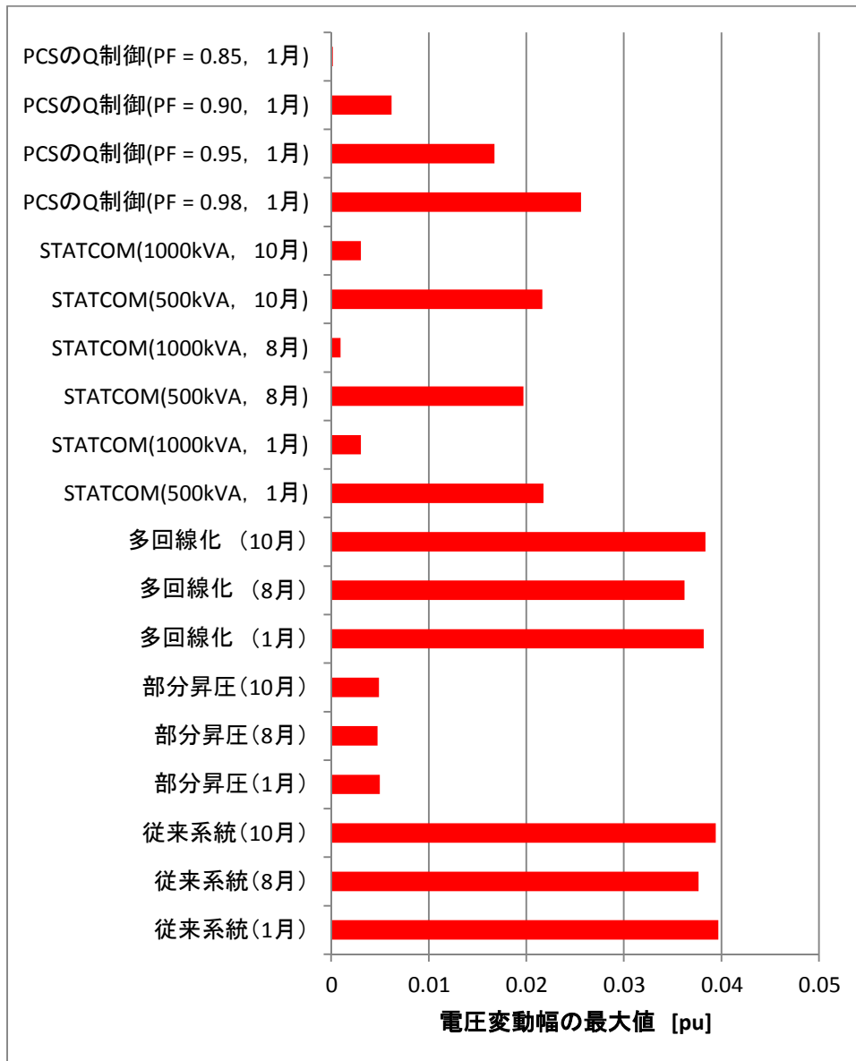
図 4.2.1-4 PV を 2500kW 集中配置した住宅地モデルの電圧変動幅
