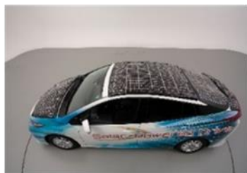
狭い面積でも十分な発電量が 得られる車載用太陽電池
