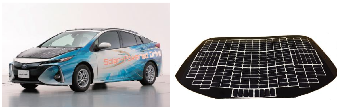
図 6-4 太陽光発電システムを搭載した公道走行用実証車と搭載したモジュール
