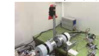
図4. 高減速比ギアードモータと 非線形弾性冗長／拮抗駆動による ロボットアーム (立命館大学)
