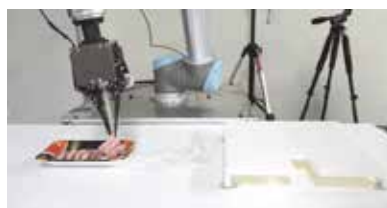
作業の実現例 左: 任意部位の切断, 中央: 柔軟食材の把持運搬, 右: 食材形状に合わせた皮むき
