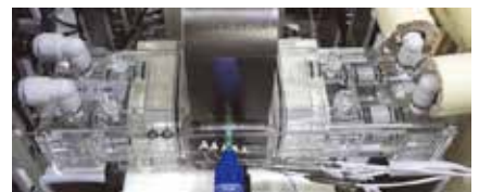
試作された高感度メタ磁性材料とカスケード型AMR試作機
