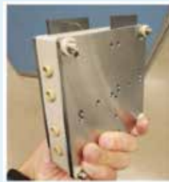
体温での発電・IoTデバイス駆動に成功したポータブル型熱化学電池（事業開始時）
