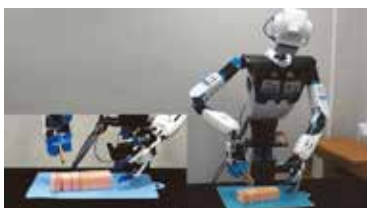
作業の実現例 左: 任意部位の切断, 中央: 柔軟食材の把持運搬, 右: 食材形状に合わせた皮むき
