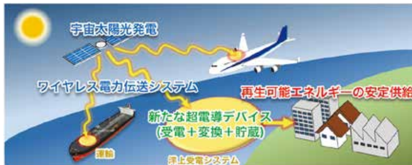
図1. 宇宙太陽光発電から洋上受電、輸送機へのワイヤレス電力伝送システムの構想。
