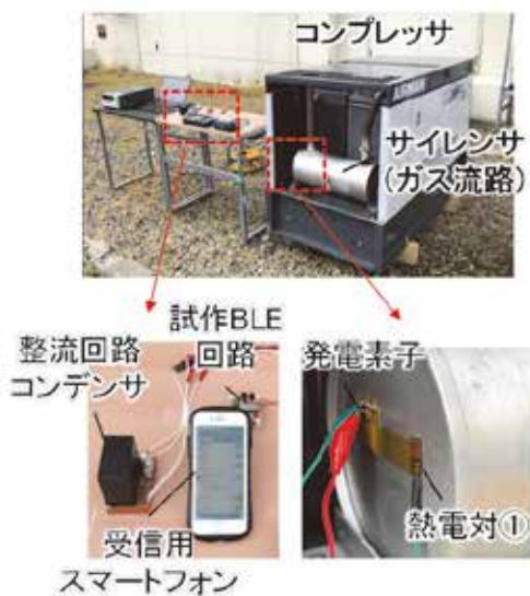
図. コンプレッサの変動排熱による発電を利用したBLE通信によるスマートフォンへのデータ送信実証試験結果
