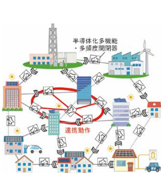
図1 電力輸送にボトルネックのない網目状送配電システム
