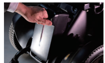
「Model C」用に開発された小型軽量で交換可能なリチウムイオン電池。
