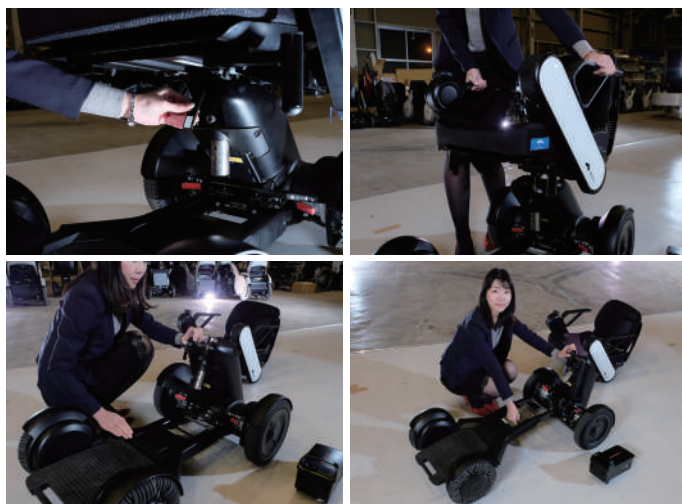
簡単に分解や組み立てが可能な「Model C」。
