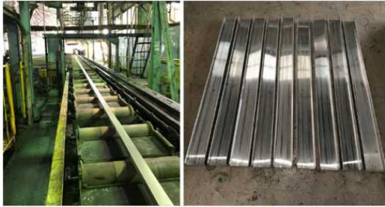
図 大型素材（20m超）の押出の様子（写真：左）とCチャンネル押出材の外観写真（写真：右）
