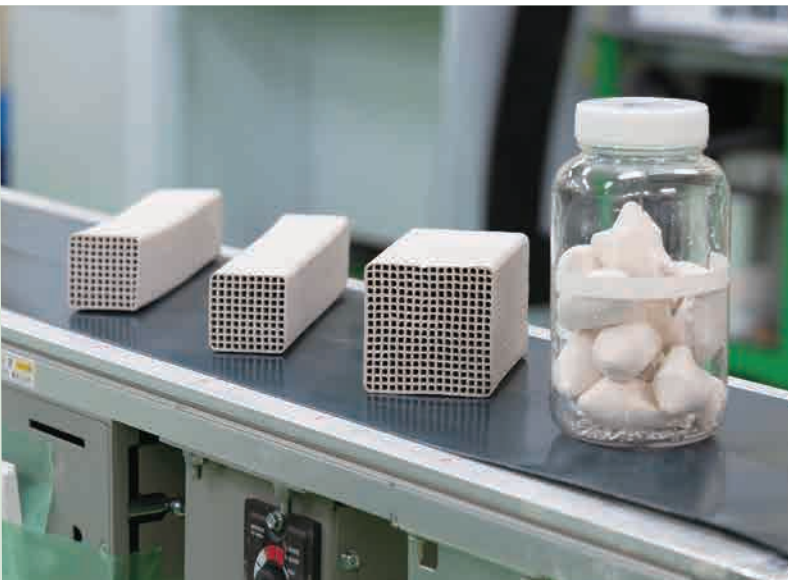
試作中のフィルタエレメント。CNFの特性評価を基にフィルタ形状の検討が進んでいる。
