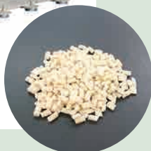
成形加工しやすいペレット状にして供給することで、製造コストと物流コストの低減を図る。
