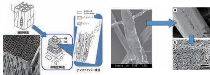
木材細胞壁の構造(左)とパルプの電子顕微鏡写真(右)
